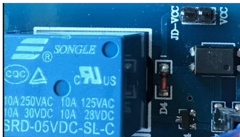
Рисунок 2.6 – Роз'єднання контактів VCC і JD-VCC на реле
