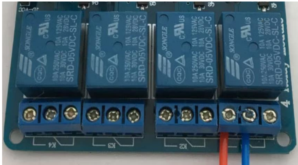
Рисунок 2.8 – З'єднання реле з двигуном гаражних воріт
