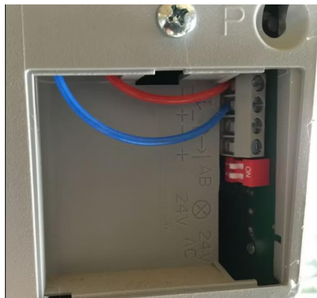
Рисунок 2.9 – Нормально розімкнена пара контактів
