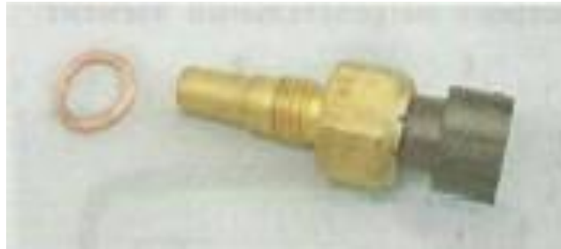
Рисунок 2.16 - Датчик температури охолоджуючої рідини з мідним кільцем ущільнювача
