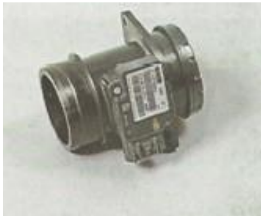
Рисунок 2.10 - Датчик масової витрати повітря
