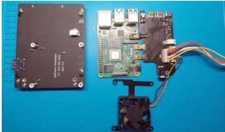
Рисунок 2.11 - Підключення плати Raspberry Pi 4В до X-C1
