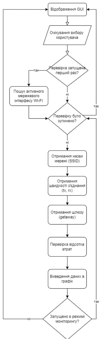
Рисунок 2.2 – Функціональна блок-схема роботи системи моніторингу якості Wi-Fi з'єднання.
