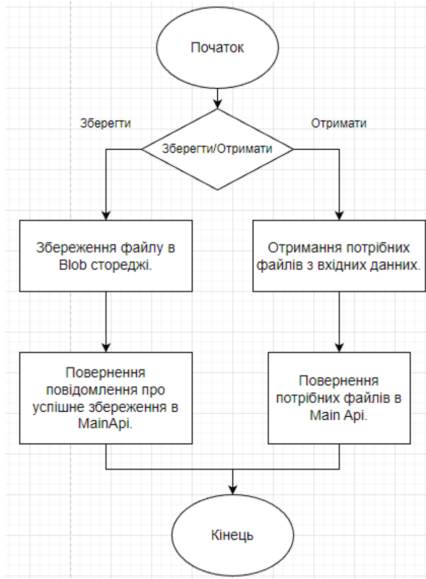
Рисунок 2.6 – Блок-схема алгоритму роботи FileManagement сервісу
