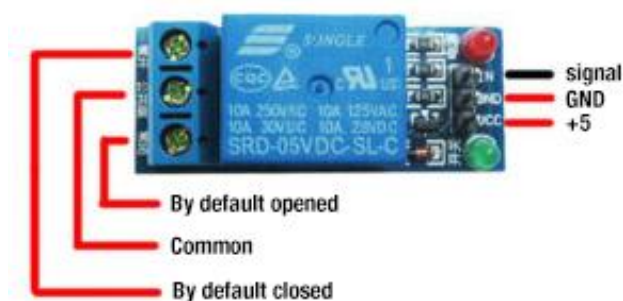
Рисунок 2.23 – Зображення виводів реле
