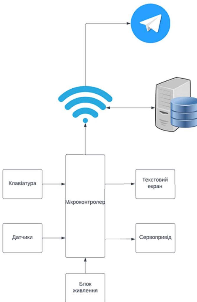
Рисунок 2.1 – Функціональна схема комп'ютеризованої системи керування паркінгом
