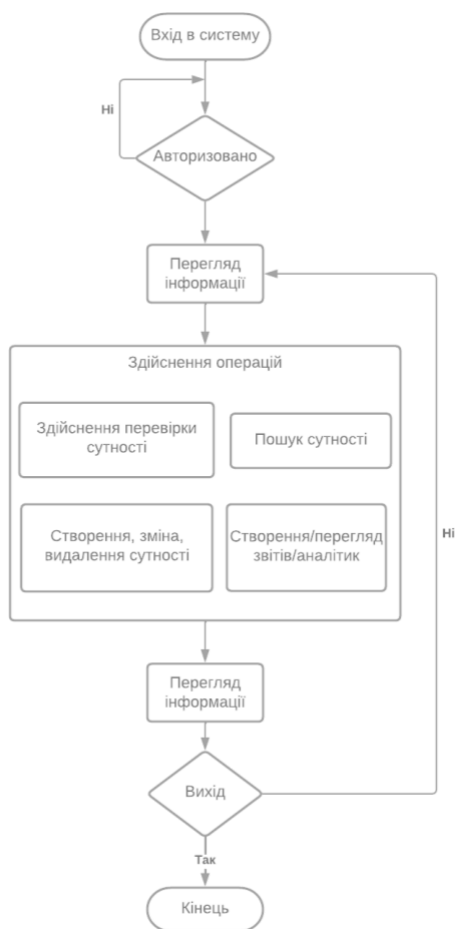
Рисунок 3.2 – Блок-схема узагальненого алгоритму роботи із NetBox
