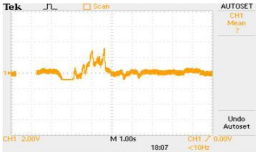
Рисунок 2.18 – ЕЕГ-сигнал з підсилувача при русі руки вгору
