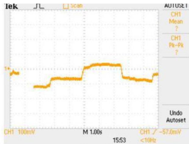
Рисунок 2.16 – Вихід активного універсального фільтра (а) і фільтра низьких частот (б)
