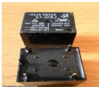
Рисунок 1.10 - Зовнішній та габаритний вигляд реле
