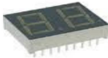
Рисунок 1.12 - Умовний вигляд індикатора LED G 2DIG AN DA04-11GWA
