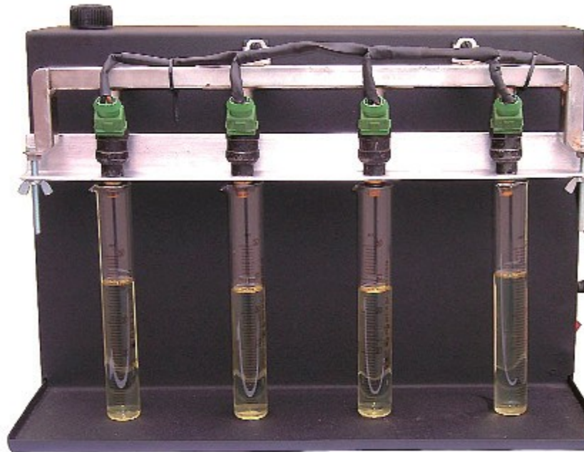
Рисунок 3.5 - Стенд для перевірки й очищення форсунок
