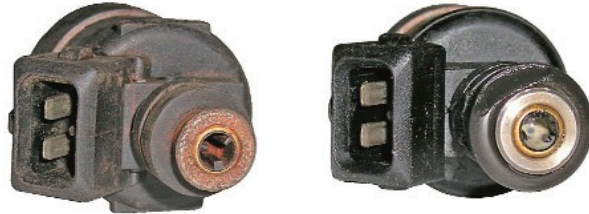
Рисунок 3.2 - Форсунок які пошкоджені і підлягають вибракуванню
