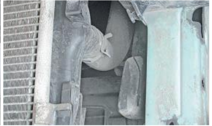
Рисунок 1.15 – З'єднання шланга з основним радіатором системи охолодження
