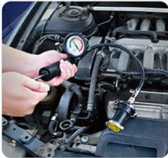
Рисунок 1.19 – Перевірка системи пневмотестером
