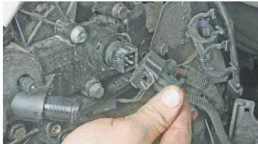
Рисунок 1.40 – Зняття роз'єму з датчика температури
