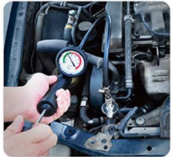
Рисунок 1.19 – Перевірка системи пневмотестером
