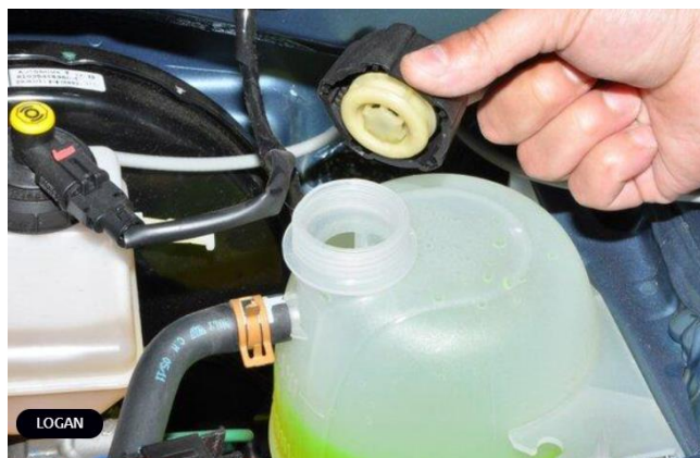
Рисунок 1.12 – Перевірка рівня і стану охолоджувальної рідини в бачку
