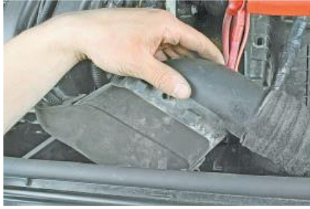
Рисунок 1.24 – Демонтаж дефлектора повітря
