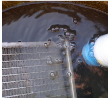
Рисунок 2.7 – Визначення місця протікання
