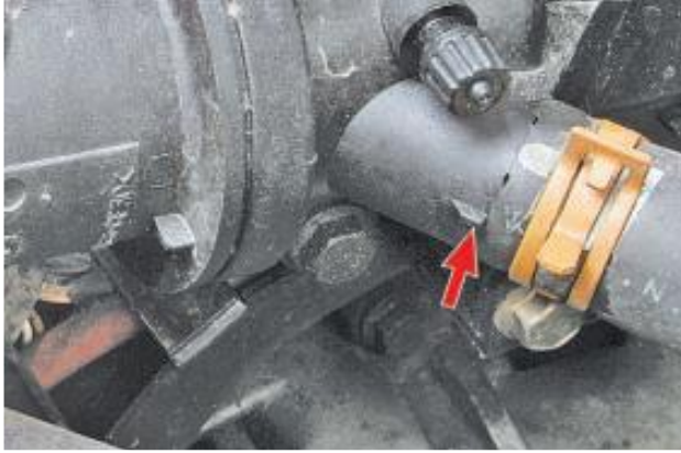
Рисунок 1.14 – З'єднання шланга системи обігріву салону з розподільником
