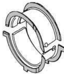
Рисунок 1.21 – Встановлення кілець для регулювання осьового зазору
