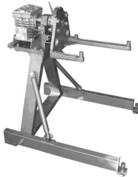
Рисунок 3.3- Стенд для автомобільних агрегатів ЛПН-078.00.000
