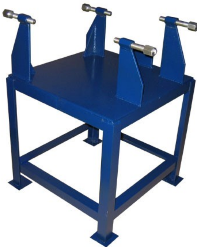
Рисунок 3.1 – Стенд для фіксації КПП під час ремонту
