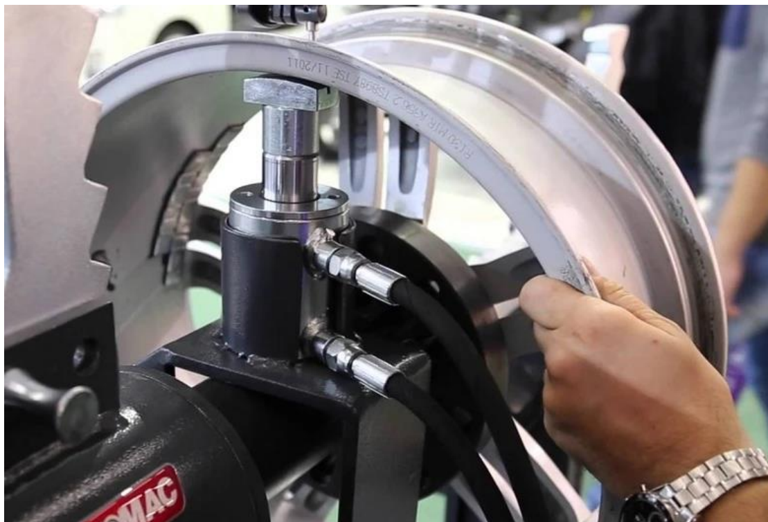
Рисунок 2.2 – Рихтування диску гідравлічним плунжером
