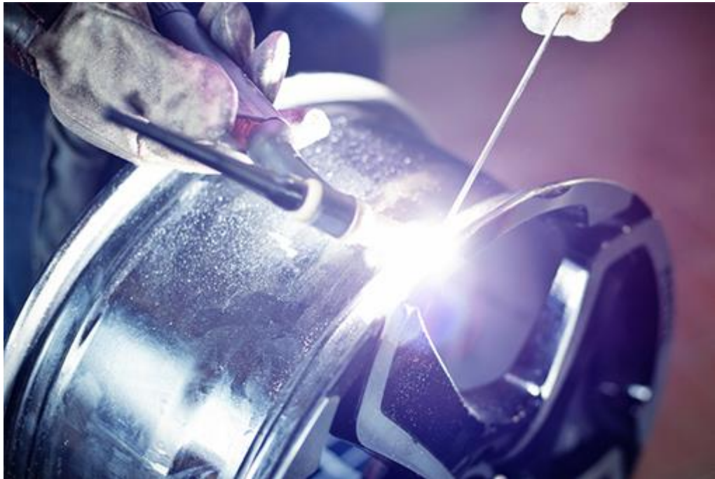
Рисунок 2.4 – Аргонно-дугове зварювання литого диска
