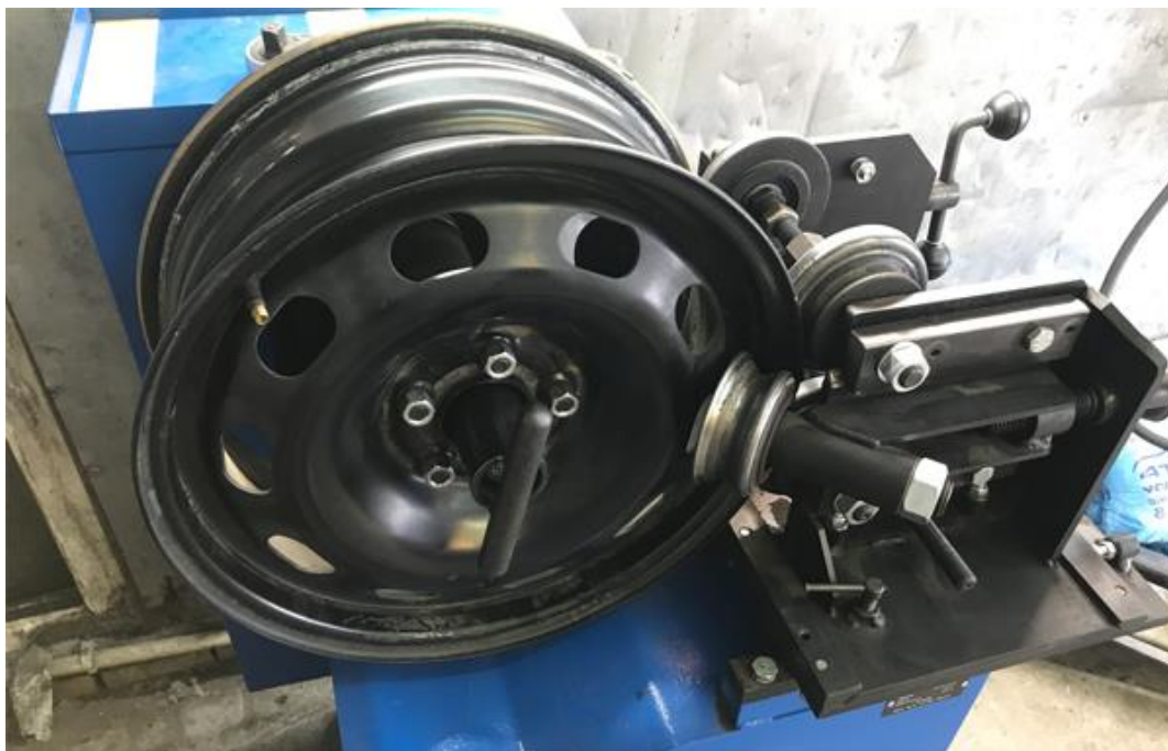
Рисунок 2.1 – Прокатування сталевого штампованого диска
