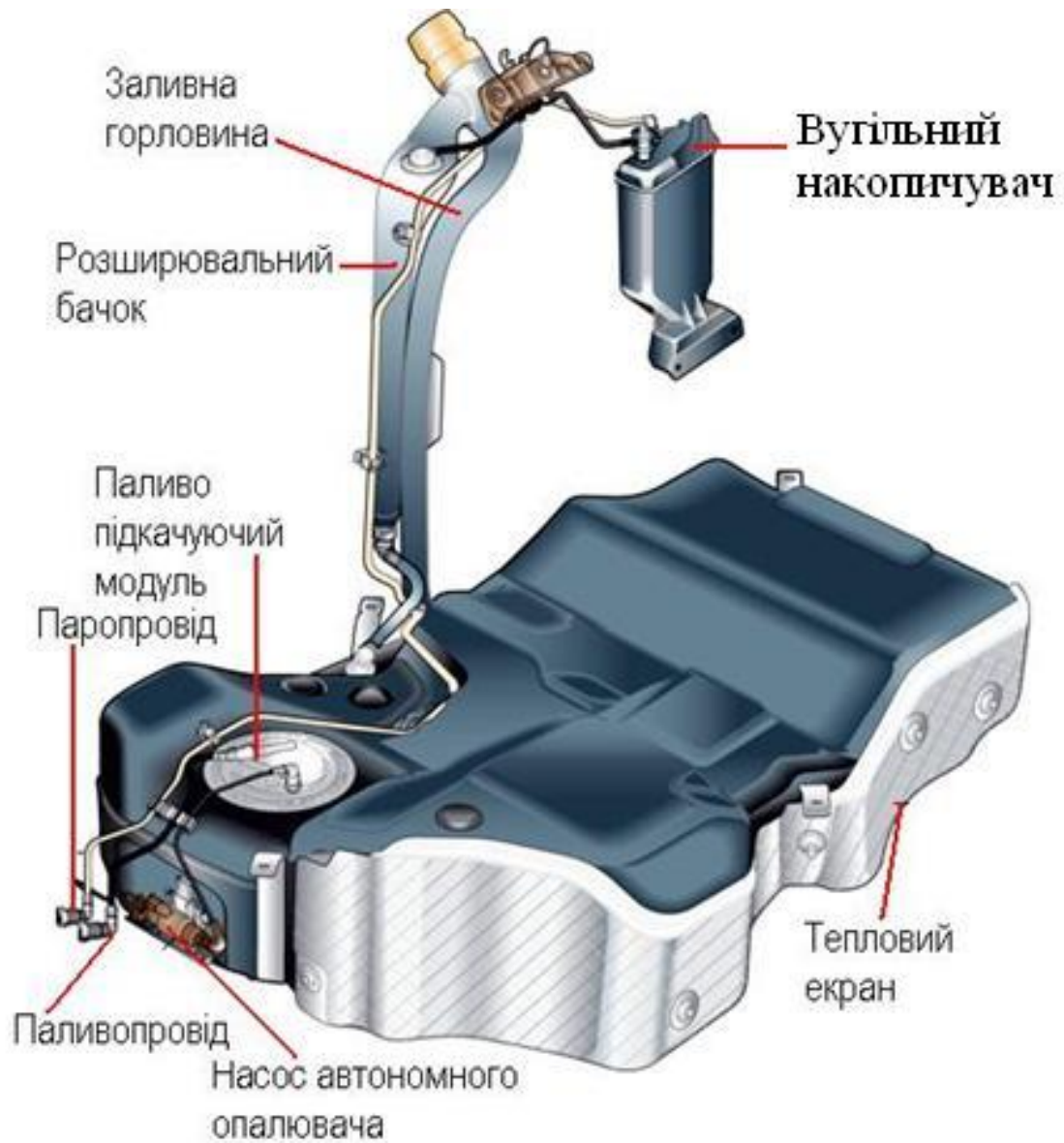
Рисунок 1.2 – Елементи сучасного паливного баку.
