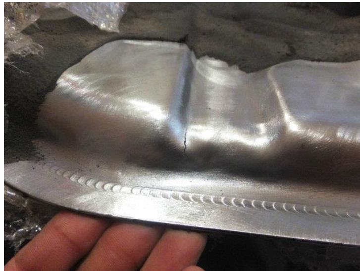
Рисунок 2.7 - Підготовка поверхні до нанесення латки
