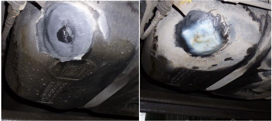
Рисунок 2.18 - Зразок ремонту пластикового бака на автомобілі: а - місце пошкодження підготовлене до ремонту, б - відремонтований бак.
