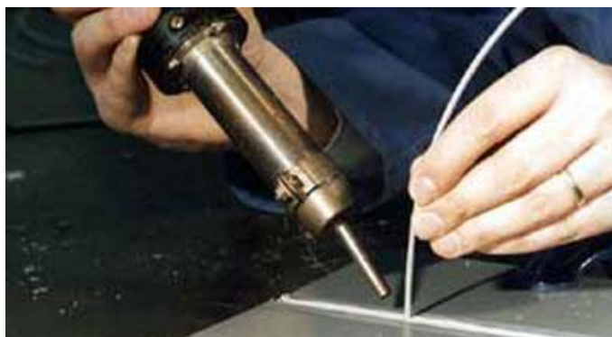
Рисунок 2.16 - Зварювання нагрітим газом
