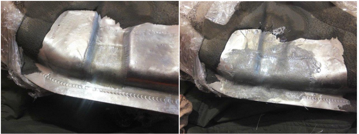
Рисунок 2.8 - Накладки із склотканини з епоксидною композицією
