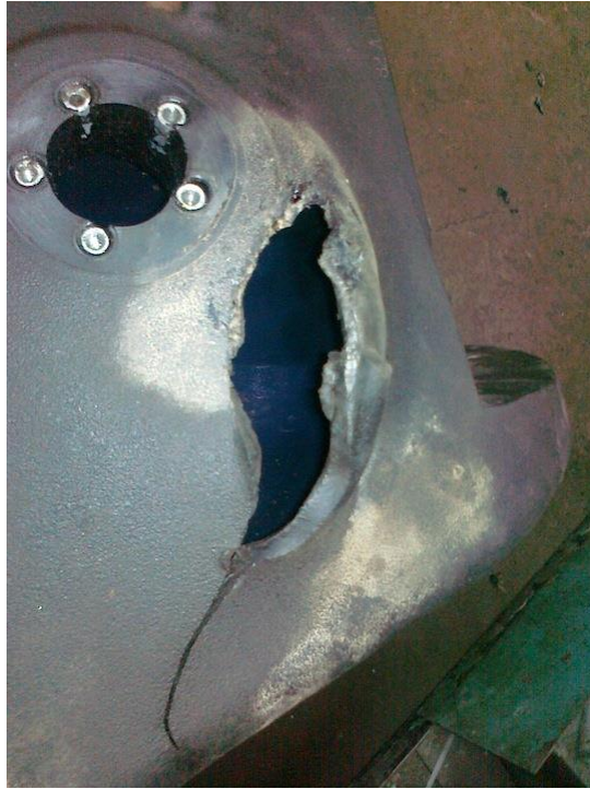
Рисунок 2.11 - Типове пошкодження паливного пластикового бака
