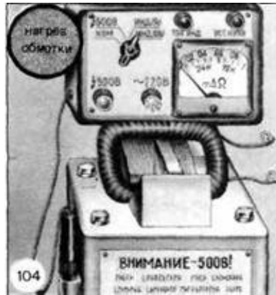
Рисунок 3.10 - Проверка катушки обмотки возбуждения на межвитковое замыкание
