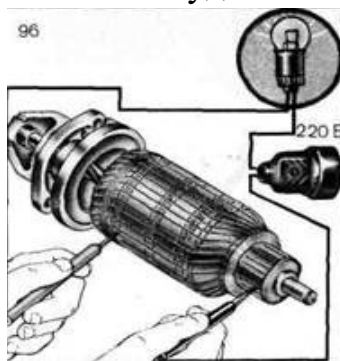
Рисунок 3.1 - Перевірка обмотки збудження на замикання з корпусом
