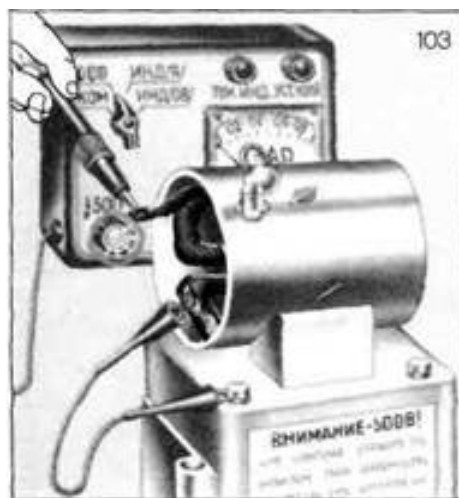
Рисунок 3.9 - Перевірка обмотки збудження на обрив
