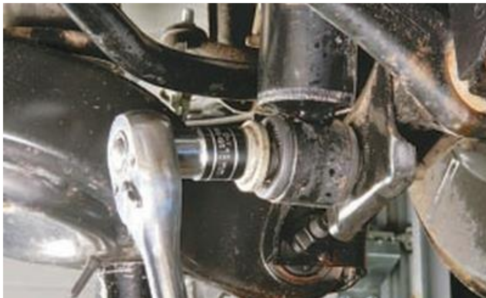
Рисунок 2.4 – Відкручування болта кріплення амортизатора
