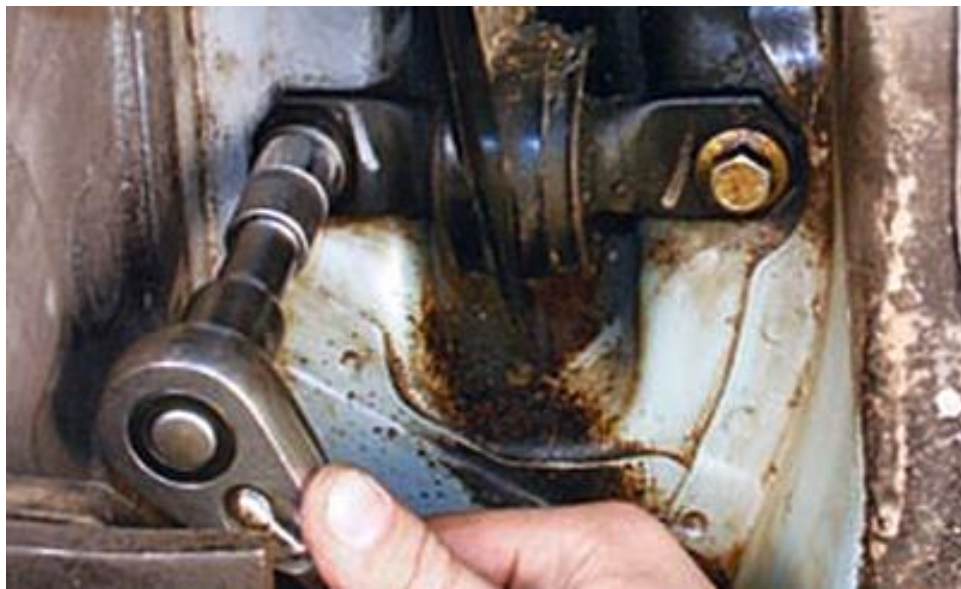
Рисунок 2.21 – Болти кронштейнів поздовжніх важелів задньої підвіски.
