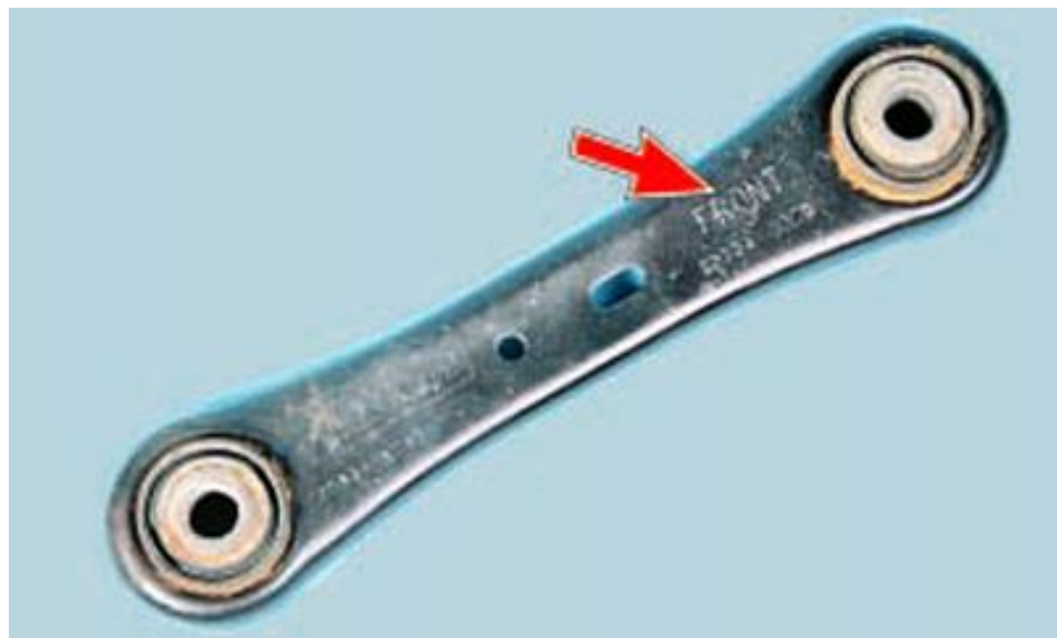
Рисунок 2.18 – Поперечний важіль (маркування FRONT)
