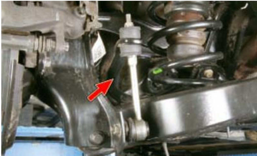
Рисунок 2.2 – Перевірка люфтів стійки стабілізатора
