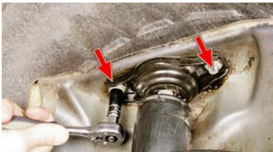
Рисунок 2.5 – Відкручування болтів кріплення верхньої опори
