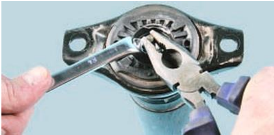
Рисунок 2.7 – Відкручування гайки кріплення верхньої опори
