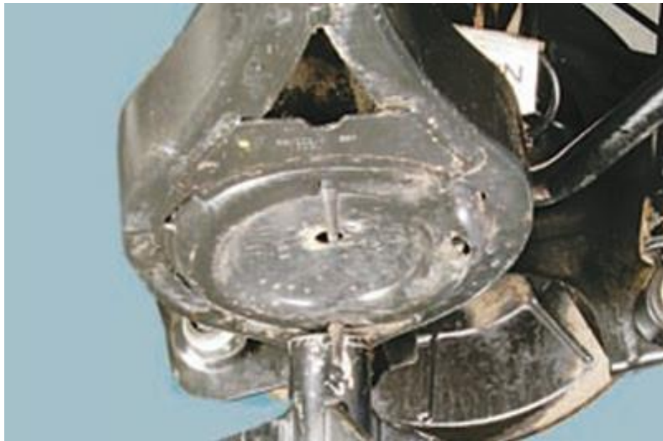
Рисунок 2.3– Встановлення домкрату під нижній важіль
