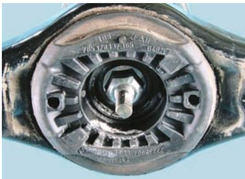
Рисунок 2.10 – Перевірка стану гумової втулки опори
