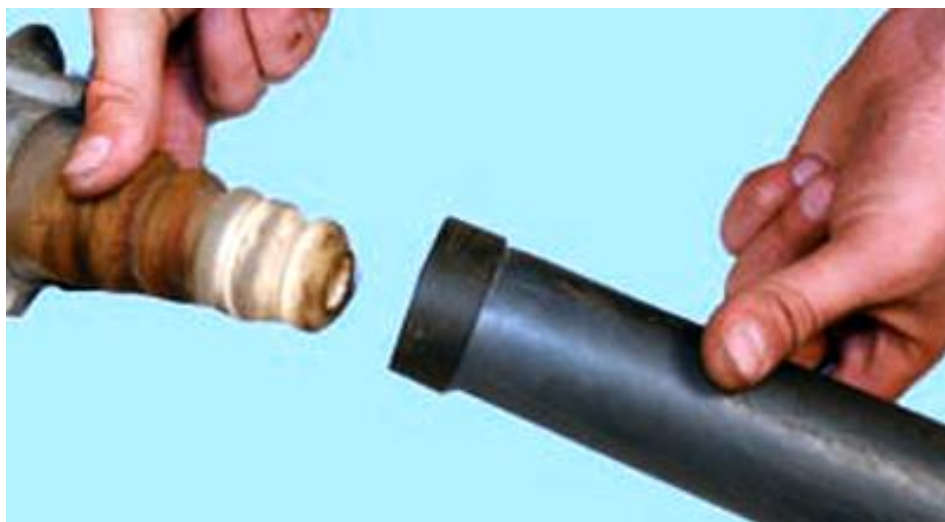
Рисунок 2.9 – Роз'єднання буфера стиснення і захисного кожуха
