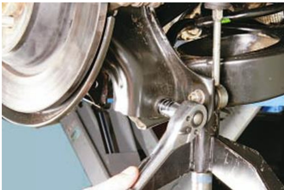
Рисунок 2.12 – Відкручування болта амортизатора від кронштейну
