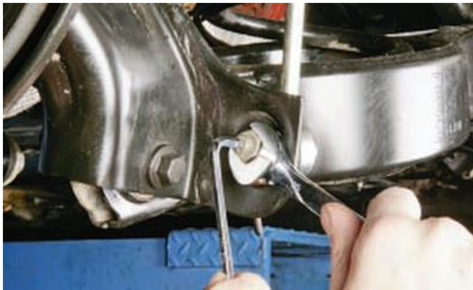
Рисунок 2.11 – Відкручування гайки кріплення стійки стабілізатора
