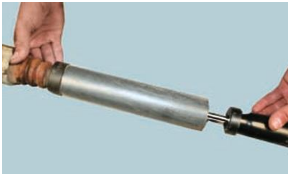
Рисунок 2.8 – Демонтаж буфера стиснення і захисного кожуха
