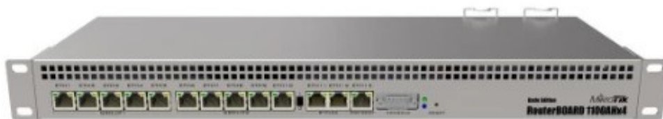
Рисунок 2.3 – Зовнішній вигляд комутатора Mikrotik RB1100x4
