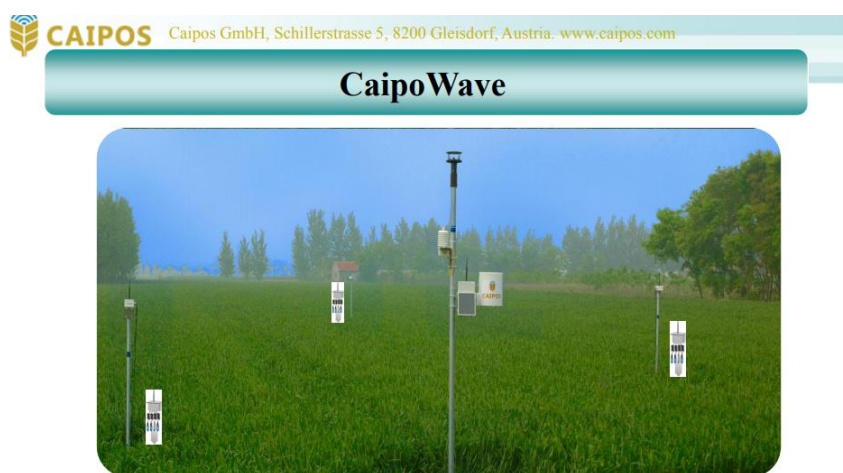
Рисунок 1.3 – Сенсорна мережа для моніторингу вологості і температури ґрунту CaipoWave
