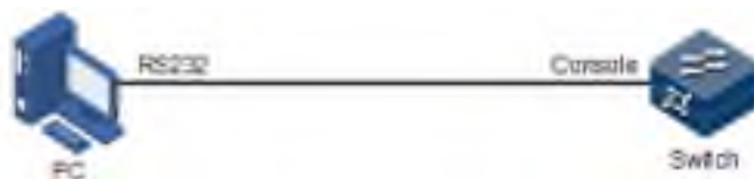
Рисунок 3.2 – Підключення до консольного порту
