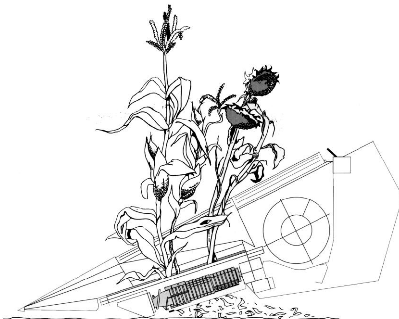
Рисунок 3.7 – Технологічна схема роботи універсального пристосування для збирання кукурудзи
