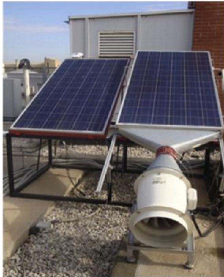
Рисунок 1.3 – Примусове повітряне охолодження фотоелектричних модулів
