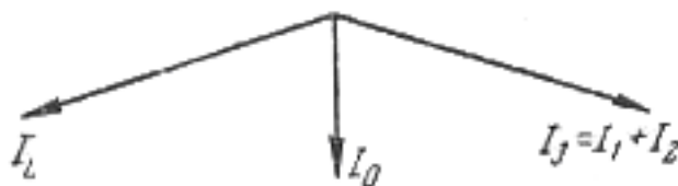
Рисунок 5 - Векторна діаграма напруг і струмів при наявності залишкового струму в місці замикання на землю
