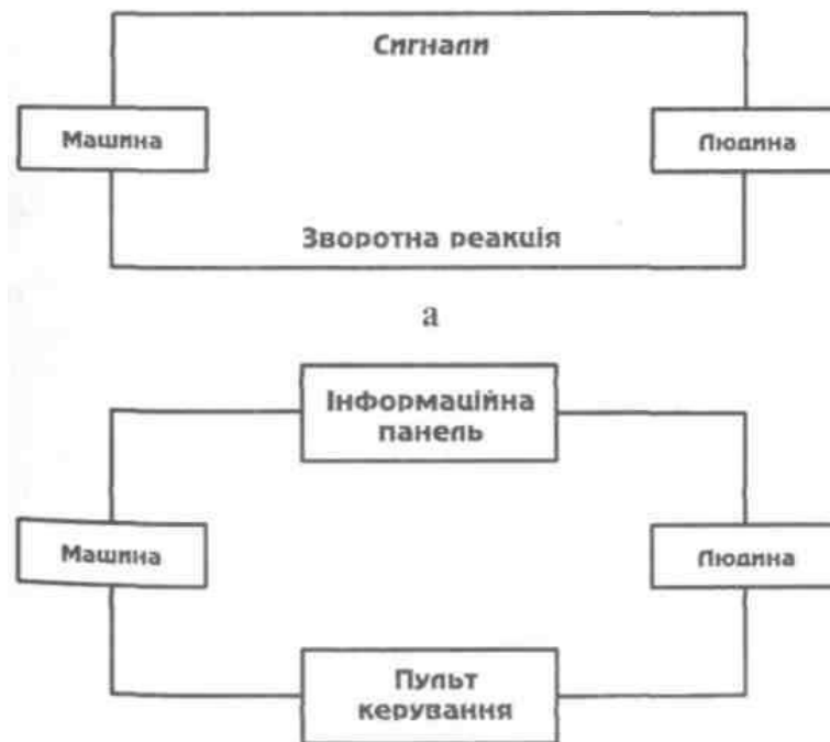
Рисунок 3.1 – Одноконтурні схеми замкненої системи «людина-машина»
