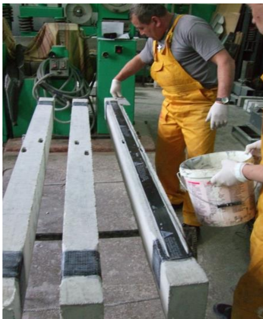
Рисунок 2.3 – Процес підсилення дослідних залізобетонних балок композитними метеріалами
