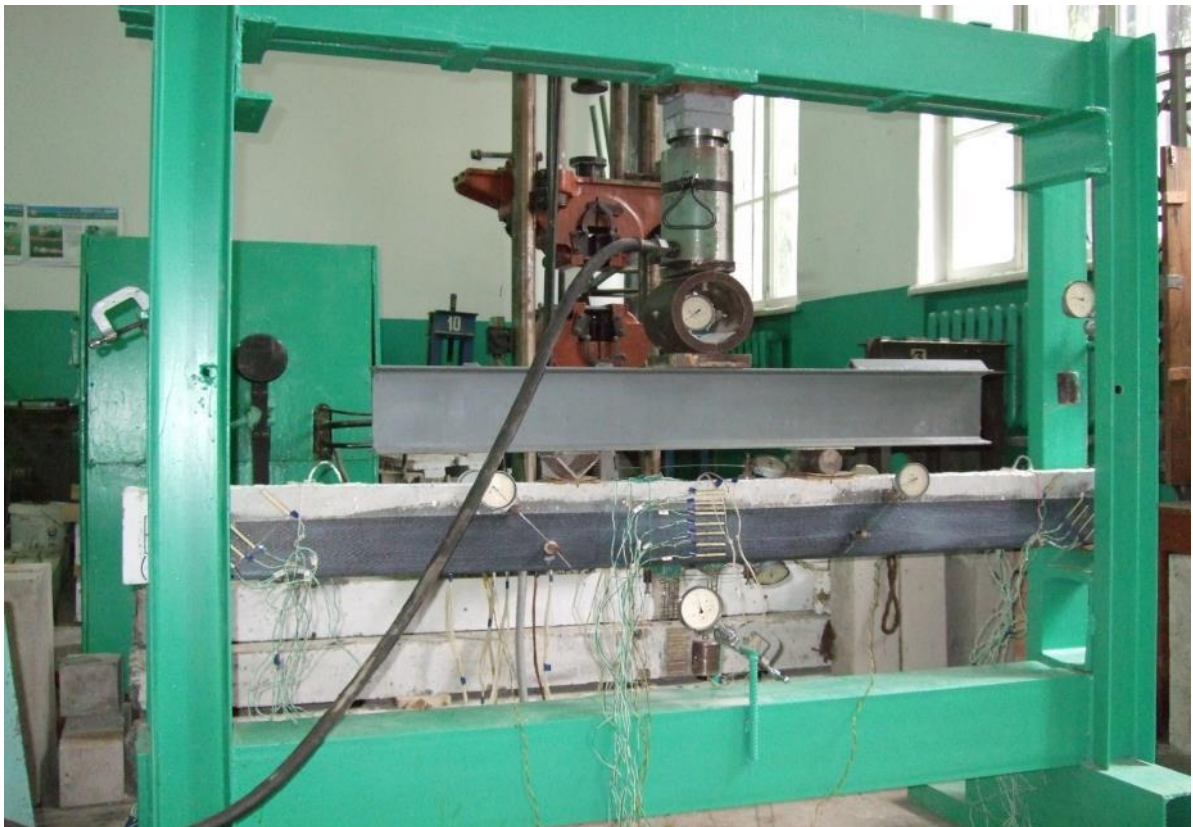
Рисунок 2.5 – Загальний вигляд балки підсиленої композитними полотном в ході експерименту
