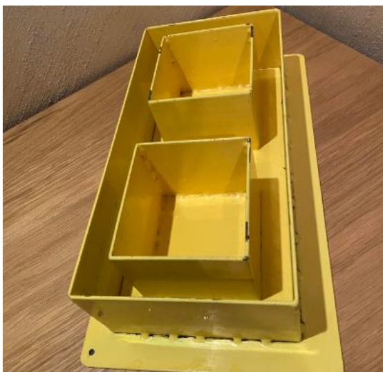
Рисунок 2.5 – Металева опалубка для формування зразків, які досліджуватимуть на теплопровідність
