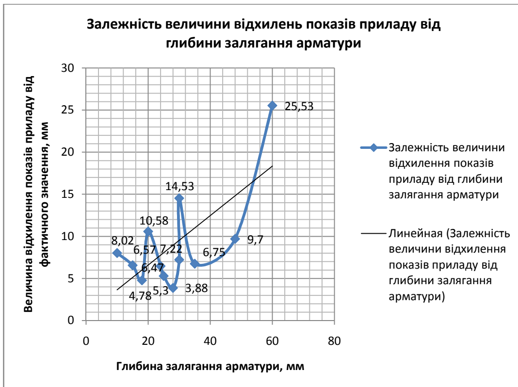
Рисунок 3.3 – Відхилення показів приладу зі збільшенням глибини залягання арматури в третьому режимі роботи пошуку захисного шару бетону при двох невідомих
