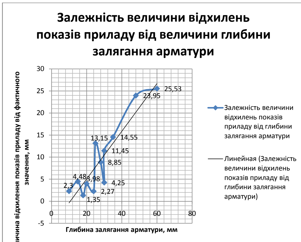
Рисунок 3.4 – Відхилення показів приладу зі збільшенням глибини залягання арматури в третьому режимі роботи при величині діаметру арматури
