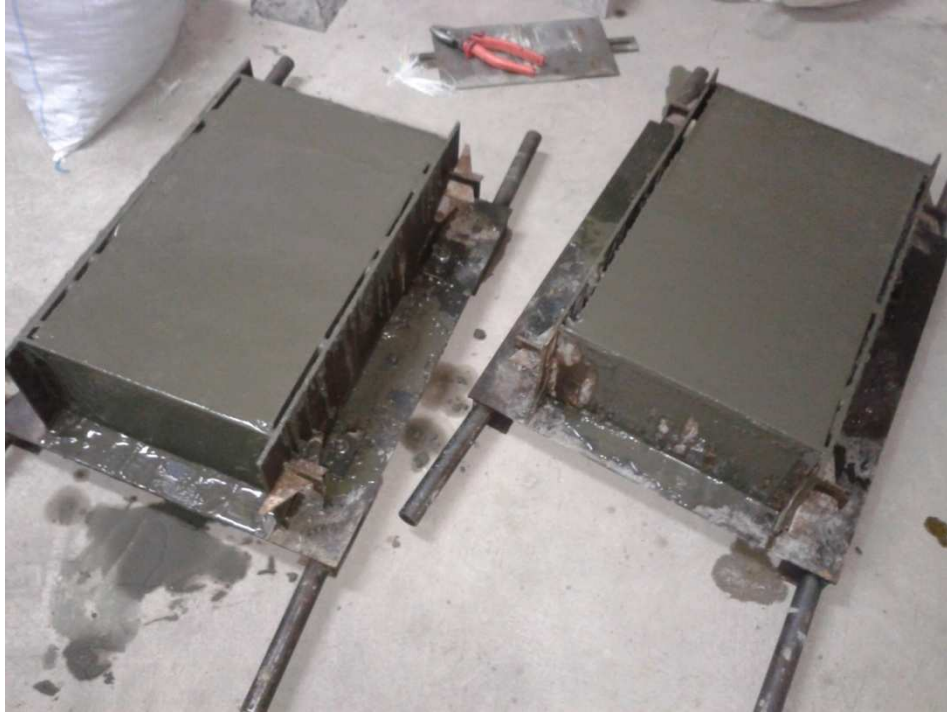
Рисунок 2.5 – Залиті форми плит №2 і №3
