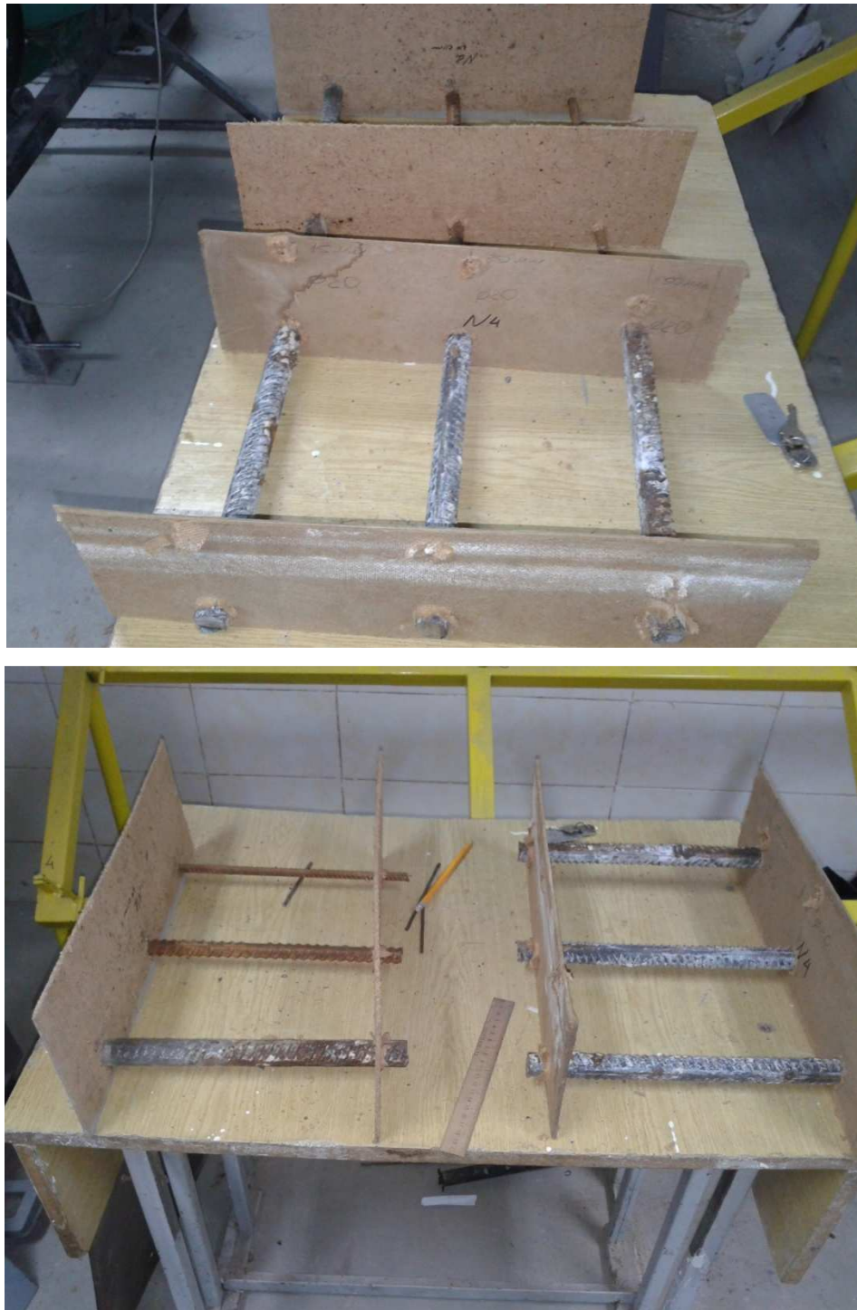
Рисунок 2.4 – Арматура в закладних деталях для плит №1 і №4
