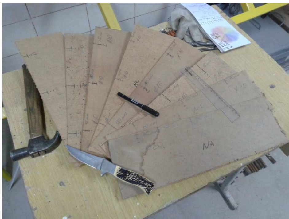
Рисунок 2.2 – Фото закладних фіксаторів положення арматури
