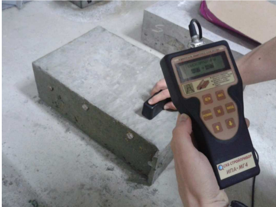
Рисунок 2.8 – Фото пошуку арматури приладом ИПА-МГ4
