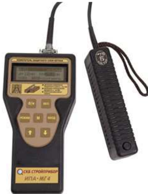
Рисунок 2.7 – Прилад пошуку арматури ИПА-МГ4
