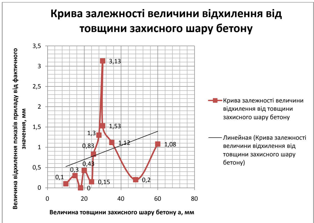
Рисунок 3.1 – Залежність величини похибки приладу від товщини захисного шару бетону в першому режимі роботи
