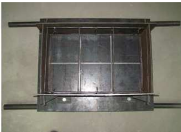
Рисунок 9 – Влаштування зварної сітки \text{Ø}4 Вр-1 у форму
