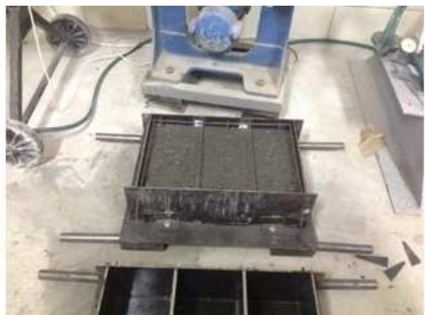
Рисунок 9 – Влаштування зварної сітки \text{Ø}4 Вр-1 у форму
