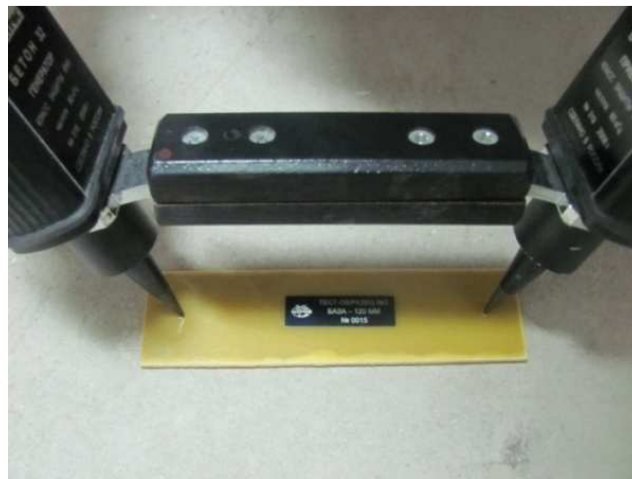
Рисунок 12 – База прозвучування поверхневим способом
