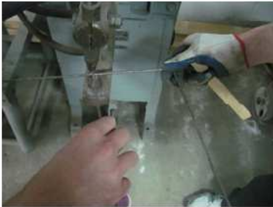
Рисунок 7 – Зварювання сітки з арматури \text{Ø}4 Вр -1 контактним зварюванням
