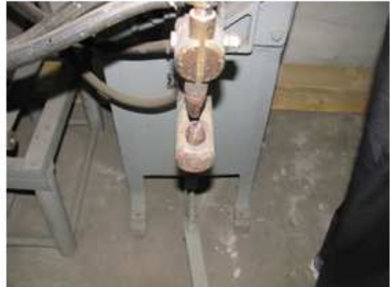
Рисунок 7 – Зварювання сітки з арматури \text{Ø}4 Вр -1 контактним зварюванням
