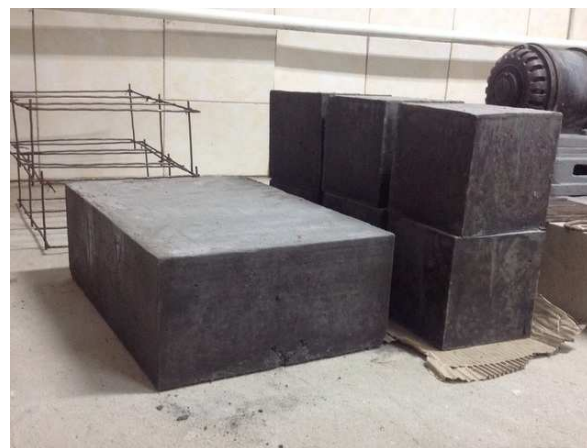
Рисунок 2 – Куби і плити виготовленні із кожного класу бетону
