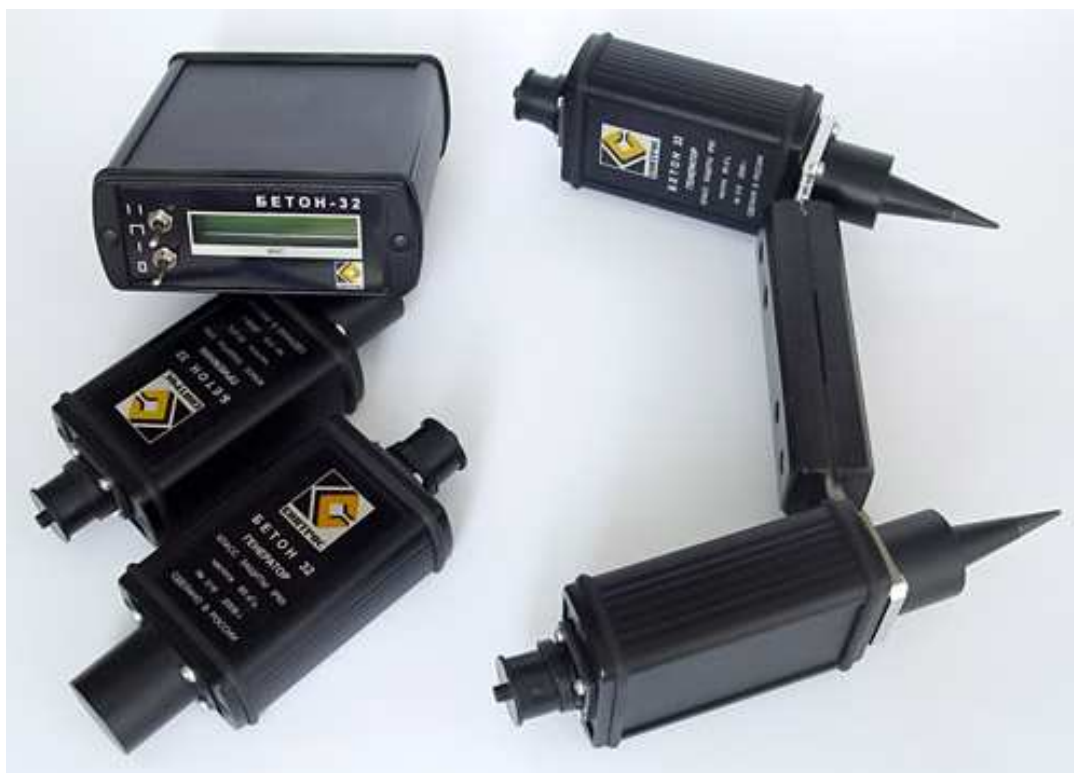
Рисунок 1 – Прилад ультразвукового контролю «Бетон-32»
