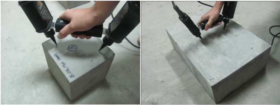
Рисунок 11 – Випробування кубів та залізобетонних плит способом поверхневого прозвучування
