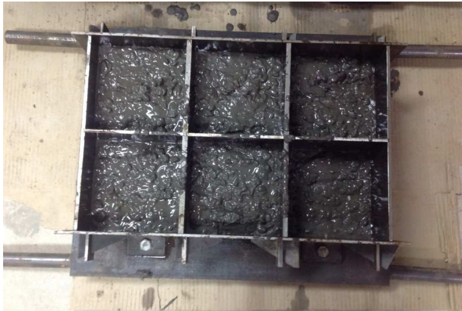
Рисунок 8 – Форма для кубів з бетоном
