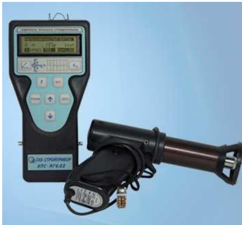
Рисунок 2 – Загальний вигляд приладу ИПС-МГ4.03
