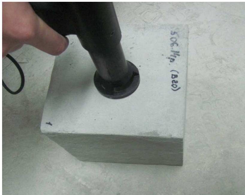
Рисунок 12 – Випробування кубів приладом ИПС-МГ 4.03
