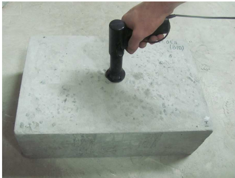
Рисунок 4.13 – Випробування плити приладом ИПС-МГ 4.03
