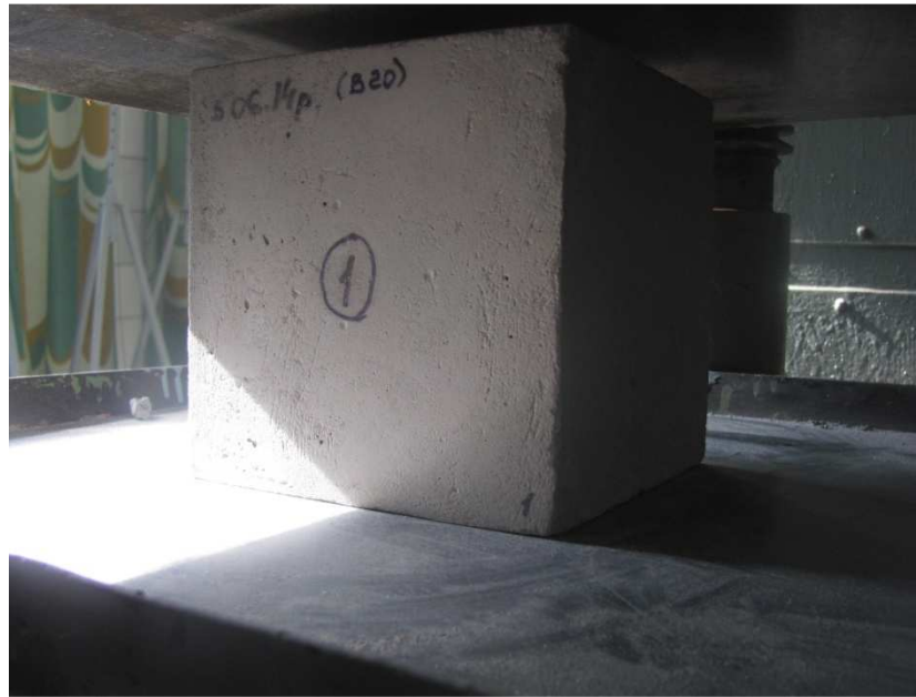
Рисунок 14 – Правильне розташування куба на пресі
