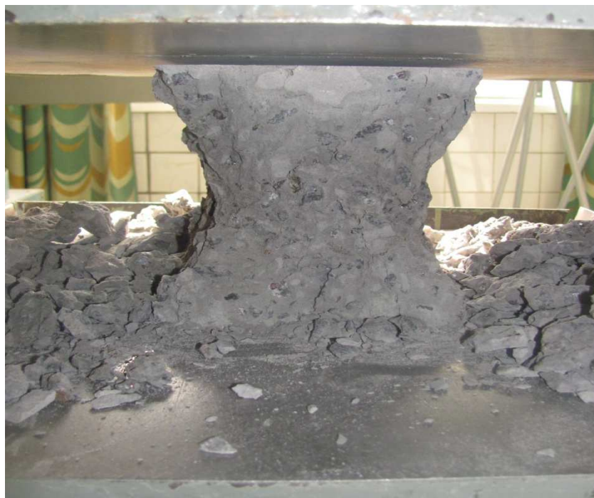
Рисунок 15 – Куб після випробування на пресі
