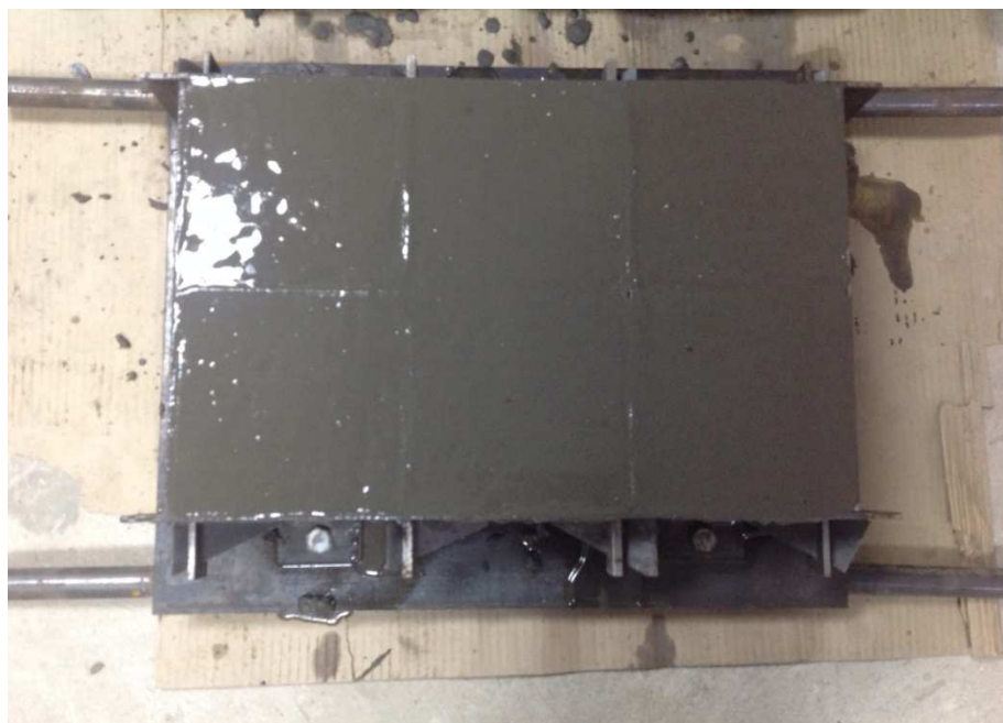
Рисунок 9 – Форма для кубів зі згладженою поверхнею бетону
