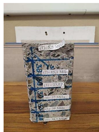
Рисунок 3.3 – Випробування зразка з плити, виконаної з порушеннями вимог зимового бетонування
