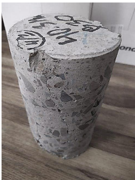
Рисунок 3.2 – Випробування зразка з плити, виконаної без порушень вимог зимового бетонування
