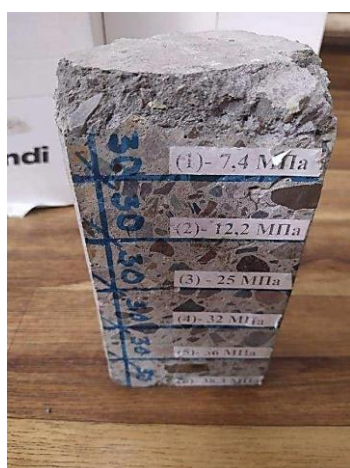
Рисунок 3.3 – Випробування зразка з плити, виконаної з порушеннями вимог зимового бетонування
