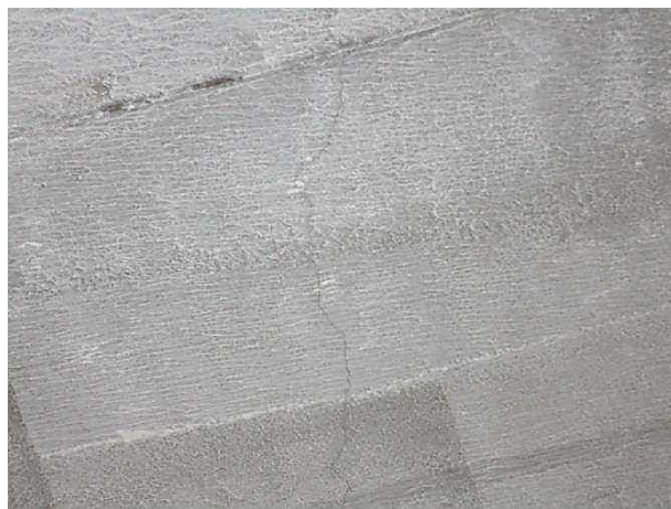
Рисунок 3.6 – Тріщини знизу плити до початку випробування
