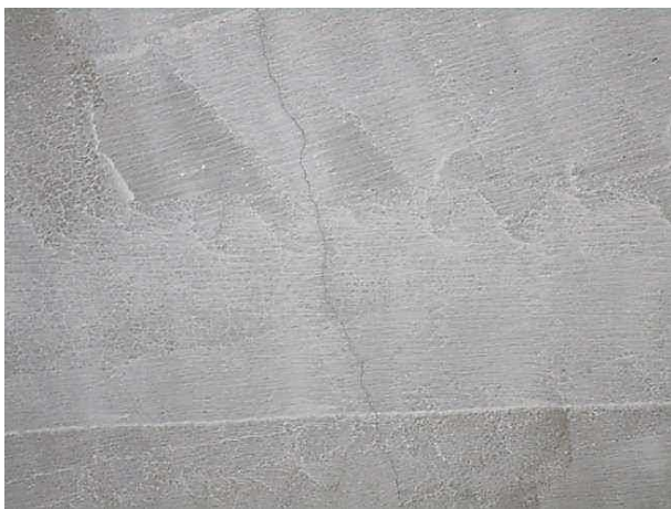
Рисунок 3.6 – Тріщини знизу плити до початку випробування
