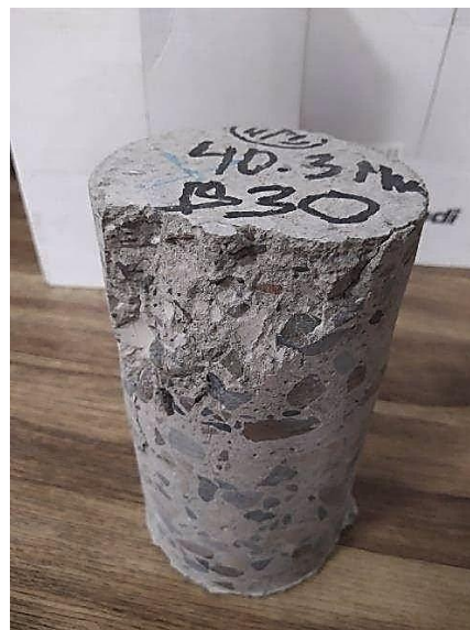
Рисунок 3.2 – Випробування зразка з плити, виконаної без порушень вимог зимового бетонування
