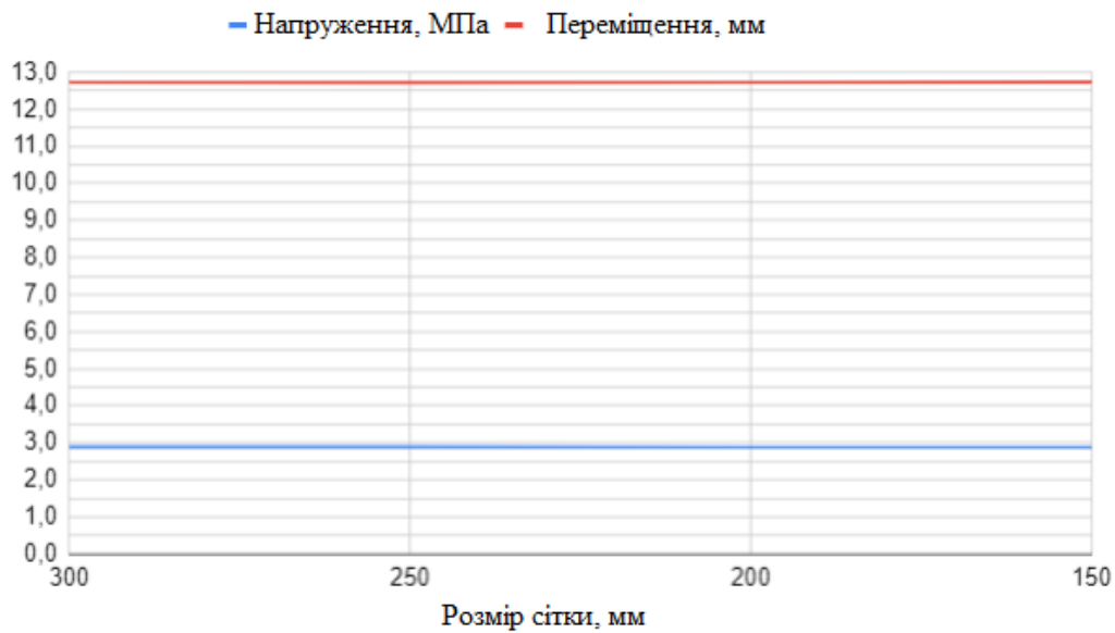
Рисунок 2.25 – Графік залежності напружень і переміщень від розміру сітки в ортотропній моделі матеріалу
