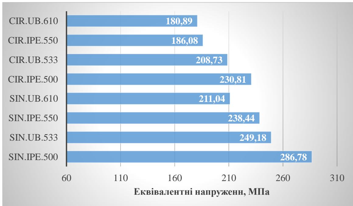
Діаграма 3.4 – Значення максимальних еквівалентних напружень в перфорованих балках з однаковими круглими (CIR) і синусоїдними (SIN) отворами, для різних типів первісних балок при схожій вазі
