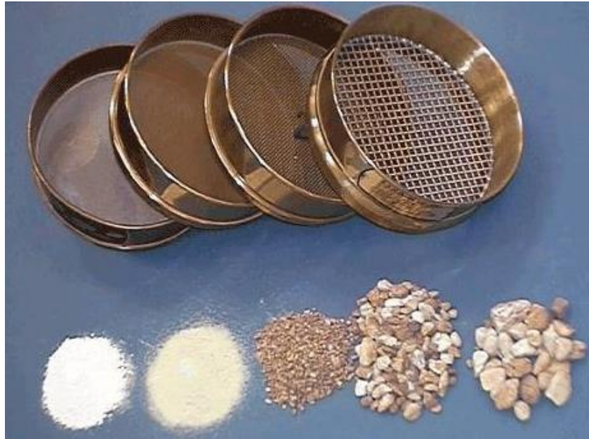
Рисунок 1.6. Сита з різними розмірами фракцій та відповідні фракції матеріалу
