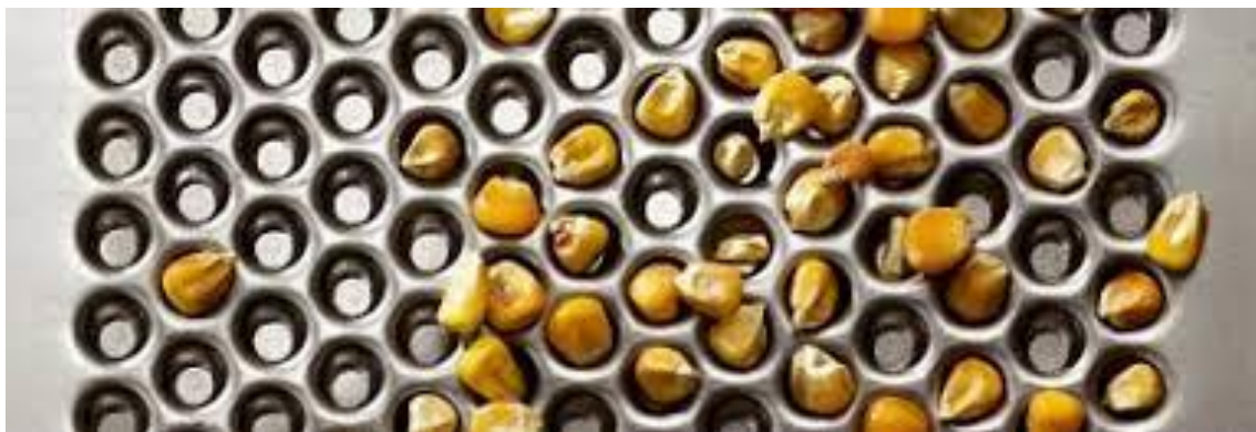
Рисунок 1.8. Комірки на поверхні барабану трієра для очистки зерна кукурудзи від домішок подовгастої форми
