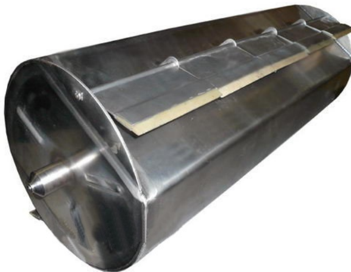
Рисунок 4.15. – Фото внутрішнього циліндра барабана маслоутворювача
