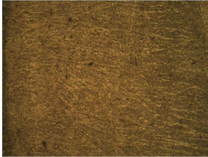
Рисунок 2.3. – Мікроструктура наплавленого металу, \times 100
