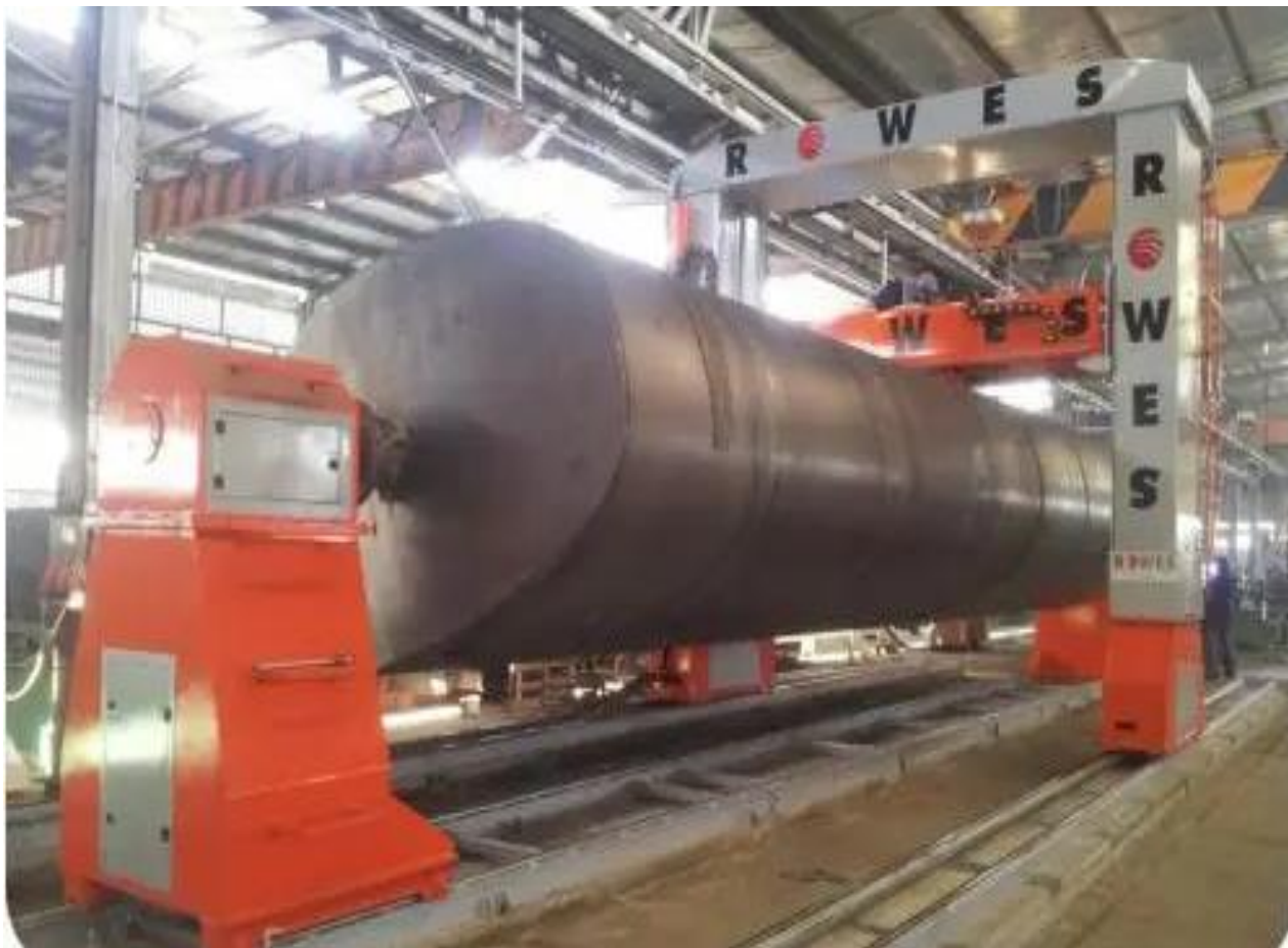
Рис. 3.13 Установка для зварювання автоцистерни [12]
