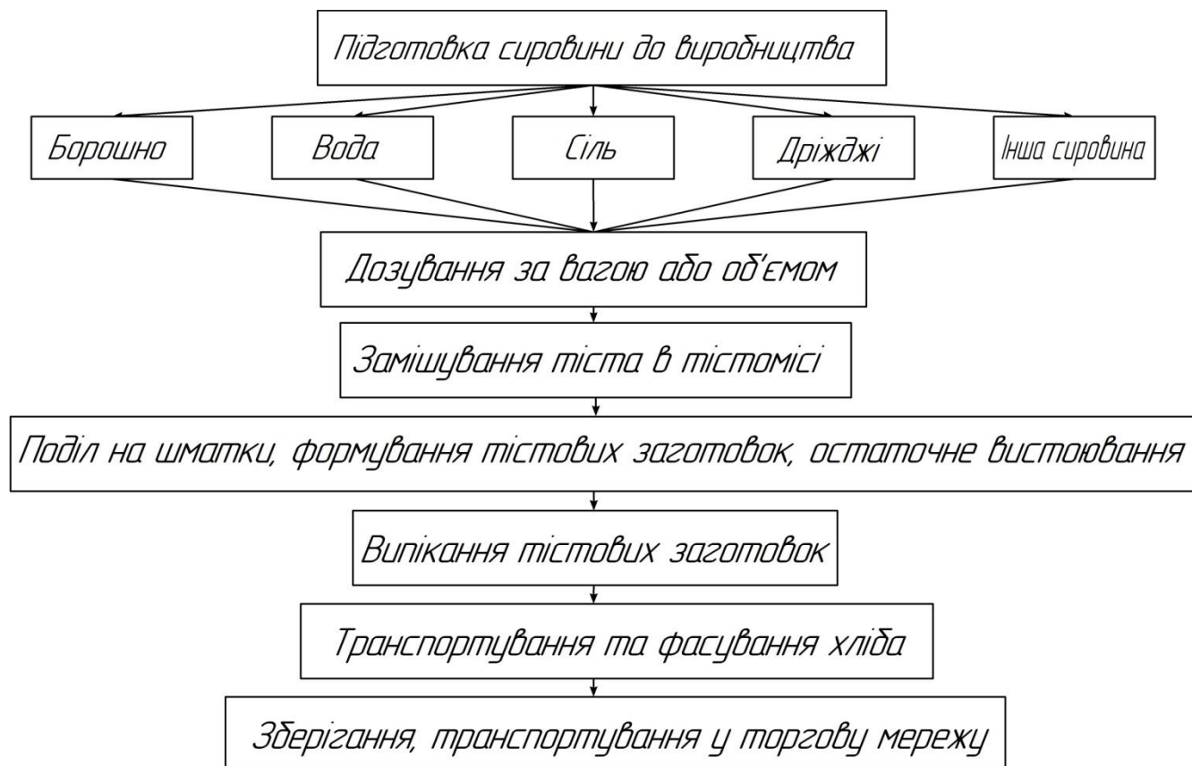
Рис. 1.14. Схема технологічного процесу виробництва тістових заготовок
