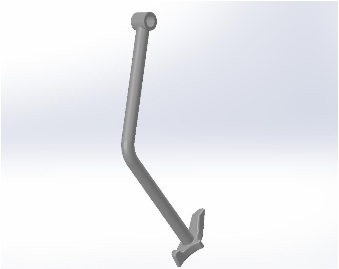
Рис. 2.3. 3D модель модернізованої лопаті тістомісильної машини Т1-ХТА
