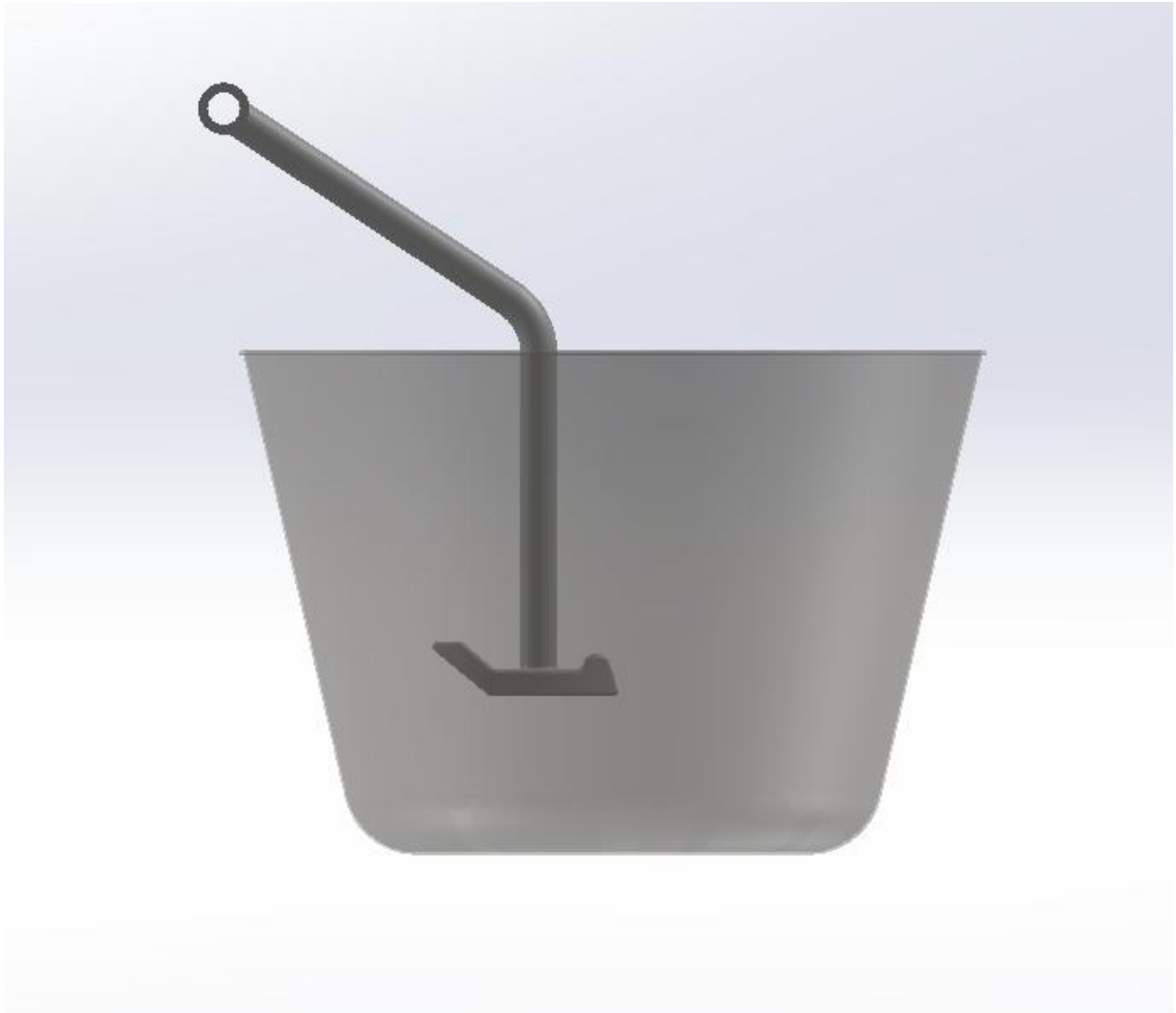
Рис. 4.1. Схема розташування місильної лопаті в діжі тістомісильної машини Т1-ХТА
