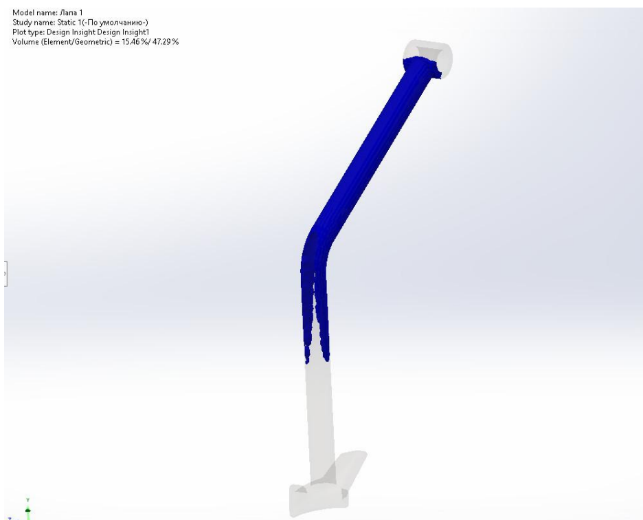
Рис. 4.8. Епюра Design Insight для навантаженої не модернізованої лопаті (висотою 150 мм та довжиною в 530 мм)
