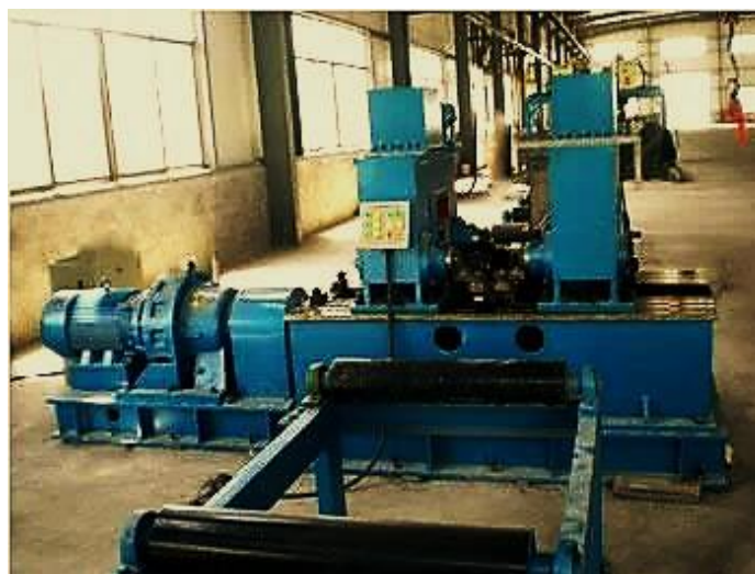
Рис. 3.15 Установка для выправления балок типу YPJ-60B [ 12]
