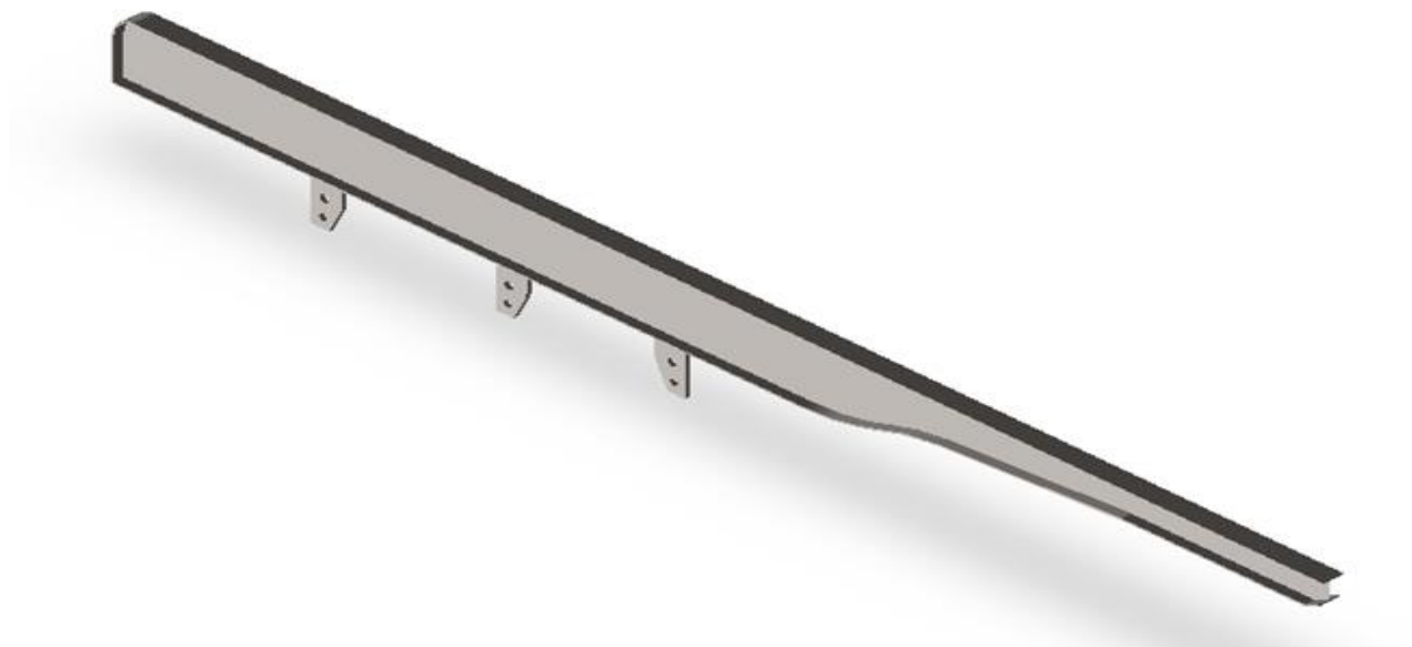
Рис. 1.2. Конструкція двотаврового лонжерона змінного перерізу
