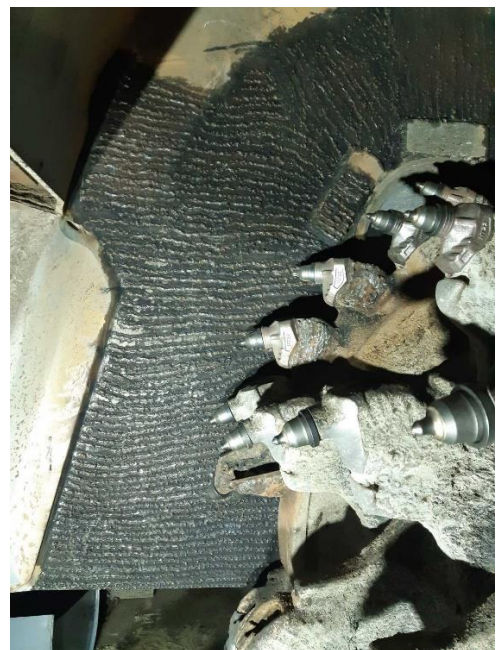
Рис. 3.12 Результати наплавлення частин фрези: а – електродом Т-590; б – порошкоподібним дротом ПП-ЗСМ-022
