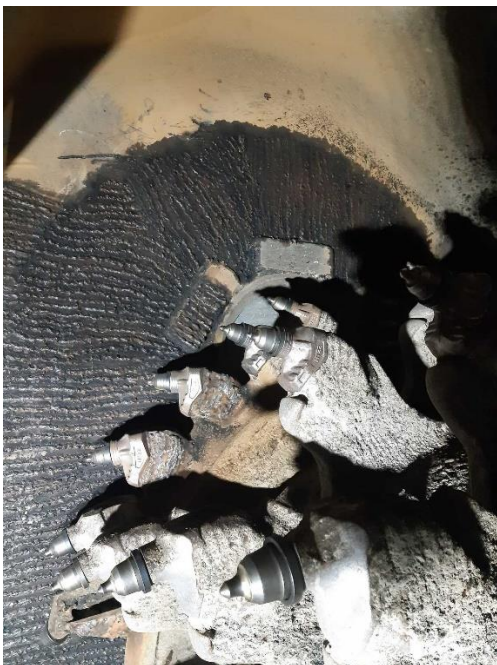
Рис. 3.12 Результати наплавлення частин фрези: а – електродом Т-590; б – порошкоподібним дротом ПП-ЗСМ-022
