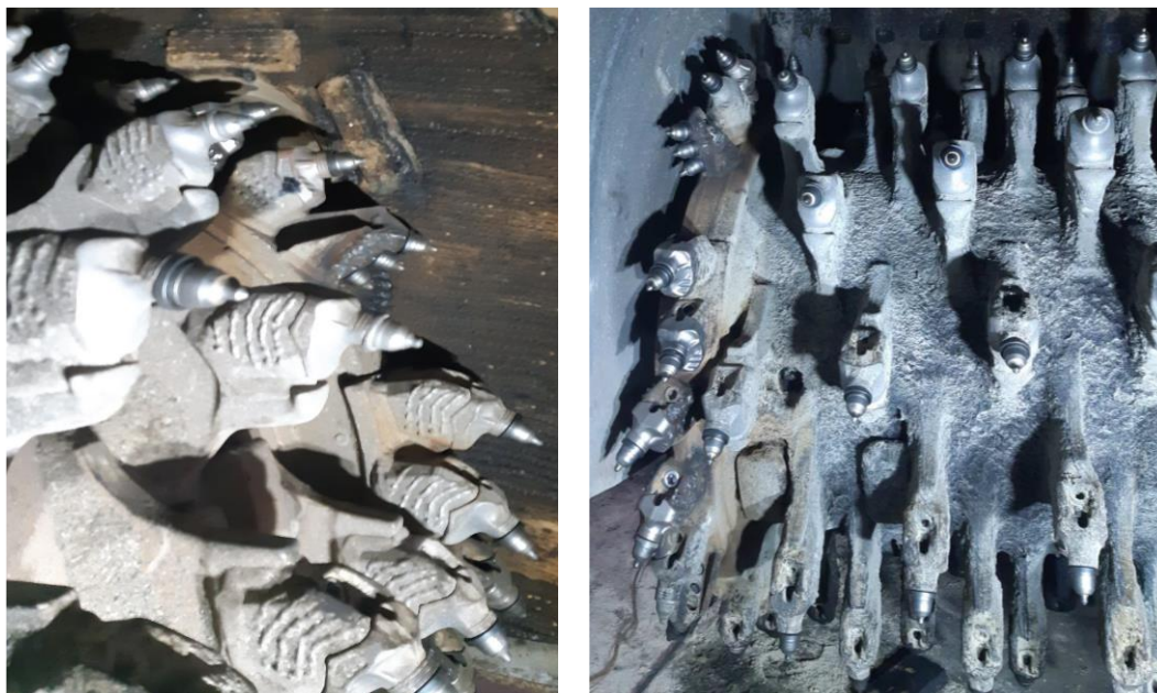
Рис. 1.5 Загальний вигляд кріплення різців на барабані фрези
