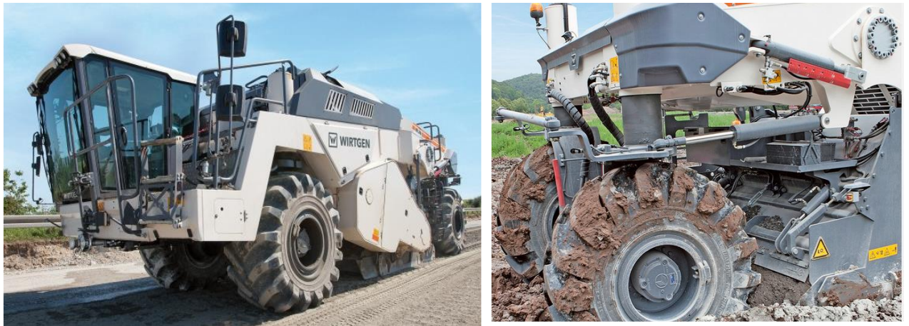
Рис. 1.1 Загальний вигляд ресайклера та стабілізатора ґрунту типу Wirtgen WR240 [2]
