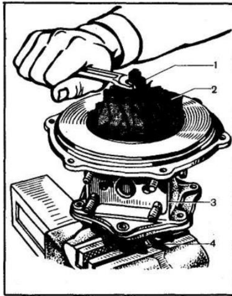
Рисунок 2.7 – Зняття колеса компресора: 1 – гайка; 2 – колесо компресора; 3 – корпус; 4 – колесо турбіни.
