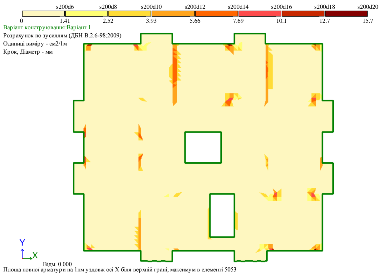
Рис. 2.15 – Мозаїка армування плити в верхній зоні по осі X, см 2 /м
