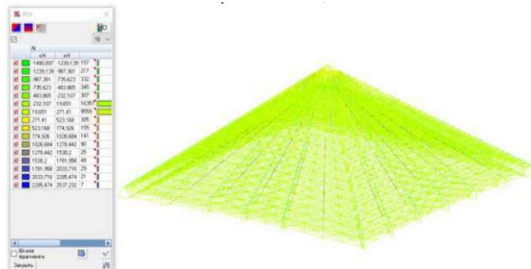
Рисунок 2.16 – Індикація розподілу поздовжніх розтягуючих зусиль в каркасі в ПК SCAD, кН
