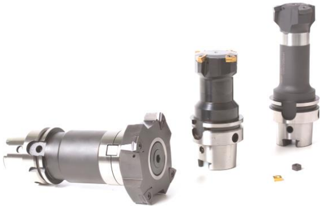
Рисунок 1.4 – Розточні інструменти TSW фірми MAPAL із стандартними ISO ріжучими пластинами [23]
