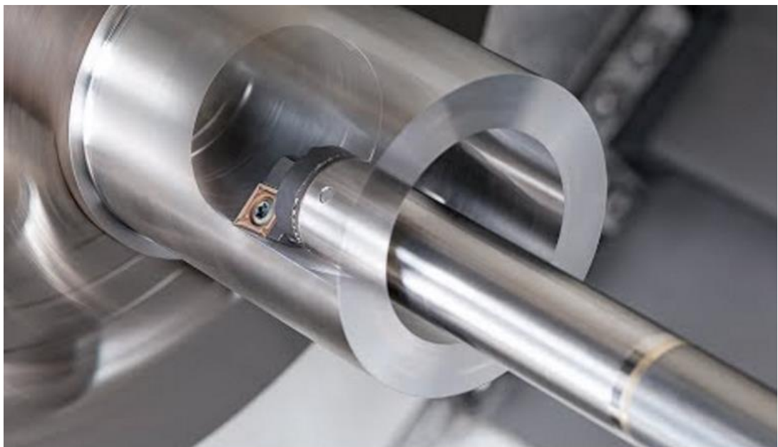
Рисунок 1.1 – Зображення процесу розточування отвору [16]
