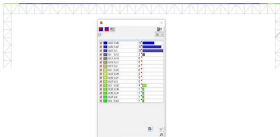
Рисунок 2.26 – Коефіцієнти використання перерізу №9 (верхній пояс рами)
