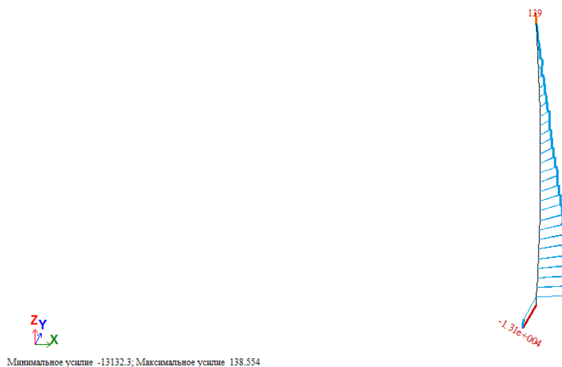
Рисунок 2.2 – Епюра N для колони по осі В-4
