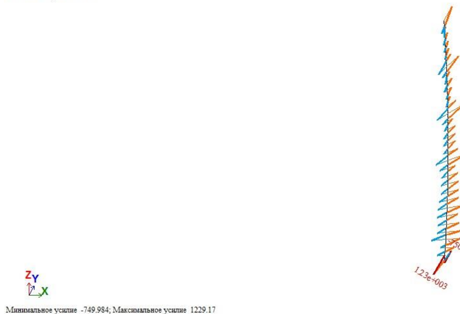
Рисунок 2.3 – Епюра Mu для колони по осі В-4
