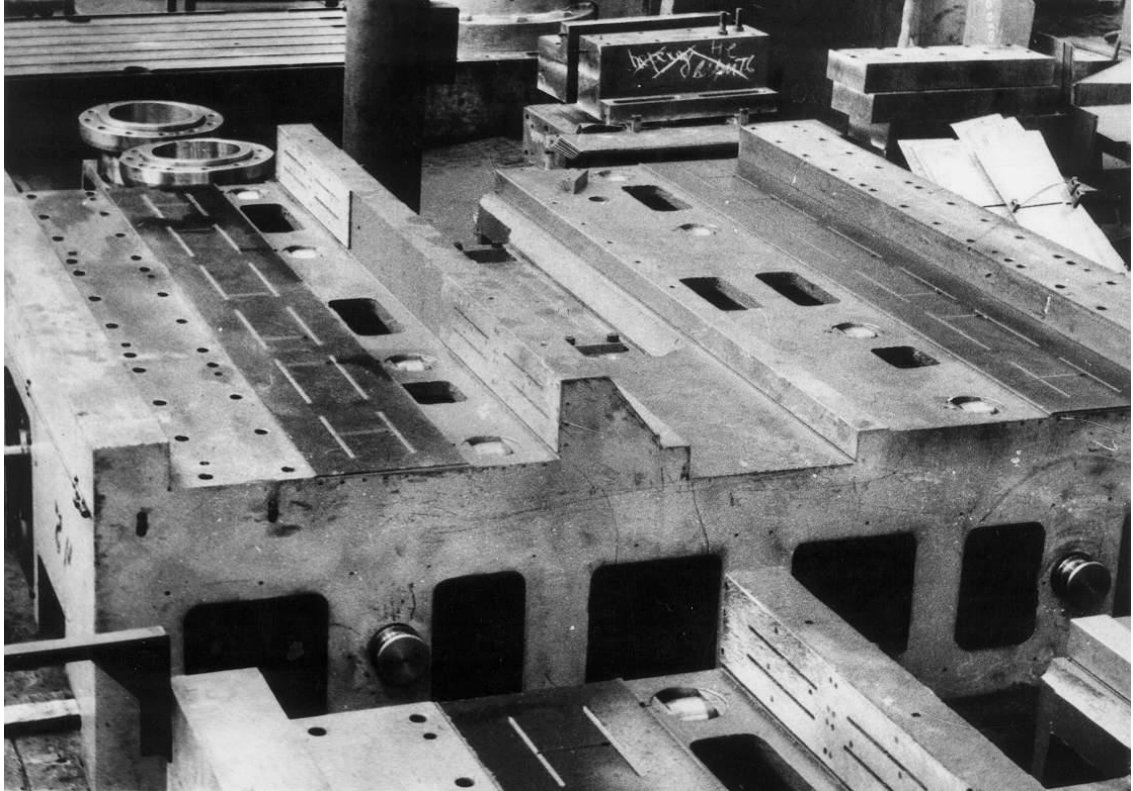
Рисунок 1.12. Гідростатичні напрямні каретки супорта верстата
