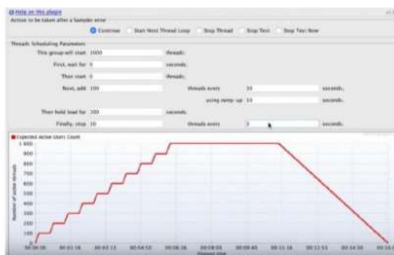
Рис. 2.6. Приклад виконання навантажувального тесту
