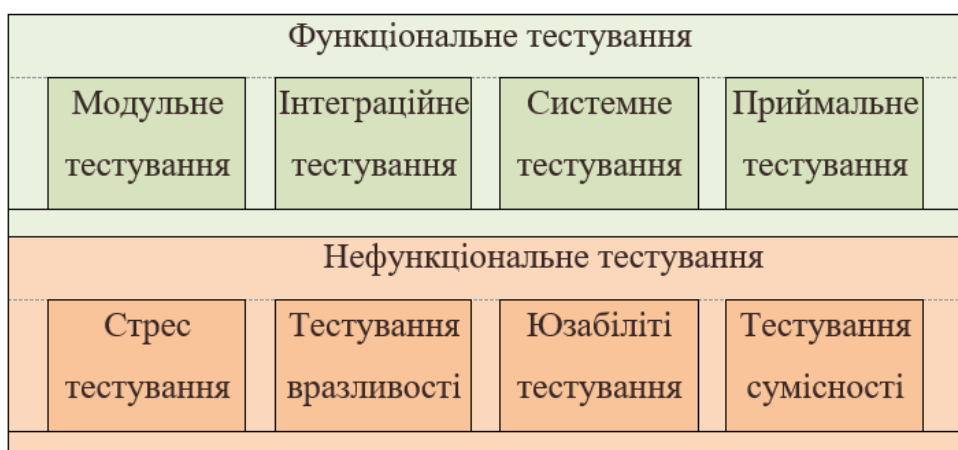
Рис. 1.2. Загальна схема основних видів тестування
