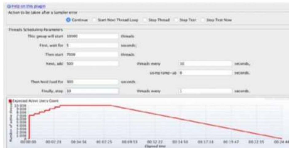
Рис. 2.7. Приклад виконання навантажувального тесту
