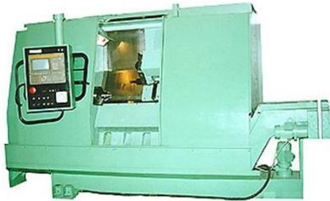
Рис. 1.3. - Верстат токарний спеціальний напівавтоматичний з ЧПК мод. РТ 777 ПР ФЗ
