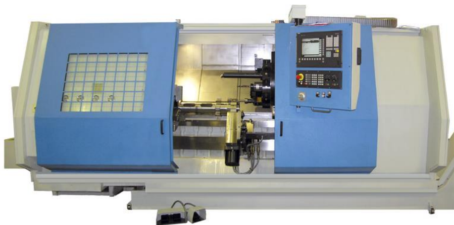
Рис. 1.4. - Токарний верстат з ЧПУ мод. САТ500
