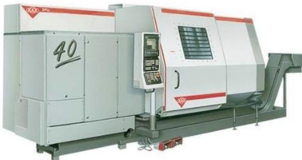
Рис. 1.1. – Токарний патронно-центровий верстат з ЧПК моделі SPU 40 CNC
