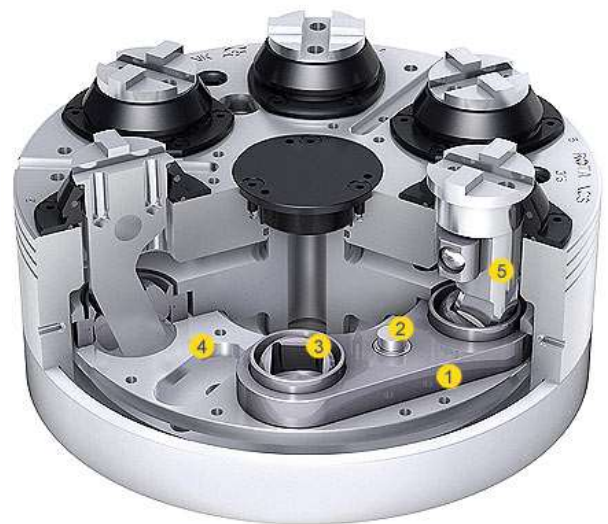
Рис. 1.5. Токарний 6-кулачковий патрон ROTA NCS фірми SCHUNK: 1 – маятниковий міст; 2 – опора маятникового моста; 3 – шарова опора важеля; 4 – привідна втулка; 5 – важіль
