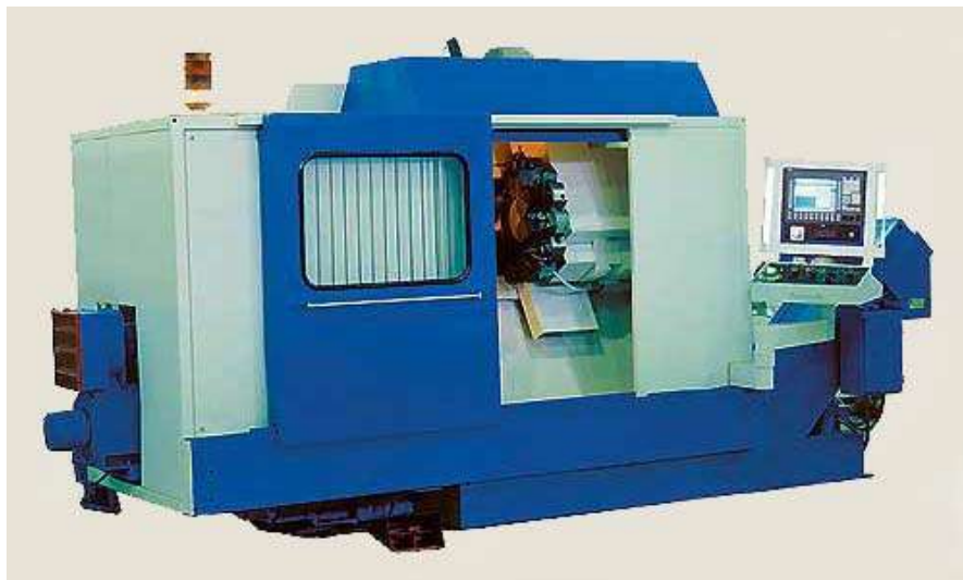
Рис. 2.1. Токарно-револьверний верстат багатоопераційний патронно-прутковий з ЧПК мод. 1П420ПФ40
