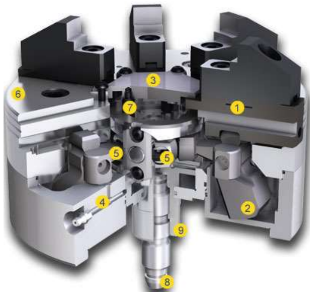
Рис. 1.4. Токарний 6-кулачковий патрон ROTA NCR фірми SCHUNK: 1 – стандартна система спряження кулачків; 2 – система зрівноваження відцентрових сил; 3 – фланець; 4 – система змащування; 5 – маятниковий міст для попарного з'єднання основних кулачків; 6 – корпус патрона; 7 – система для зміни режиму роботи з маятникового в самоцентрівний; 8 – система центральної подачі повітря і змащувально-охолоджувальної рідини; 9 – привідна втулка
